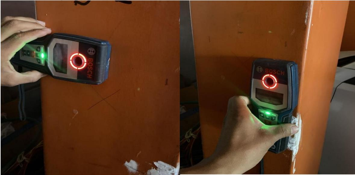
**ANEXO 8. Escaneo de acero en la columna C-2**
