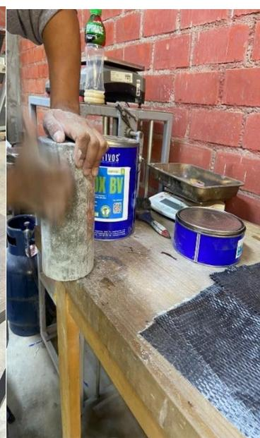
**ANEXO 21. Proceso del sellado del primer aditivo con mezclando el tipo A + B para sellar los poros y dejarlo secar por un promedio de 2 horas, de igual forma se realizara el mismo proceso para los 14 y 28 días.**
