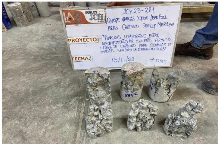
**ANEXO 20. Se realiza un desgaste de las probetas antes de realizar el refuerzo con la fibra de carbono**
