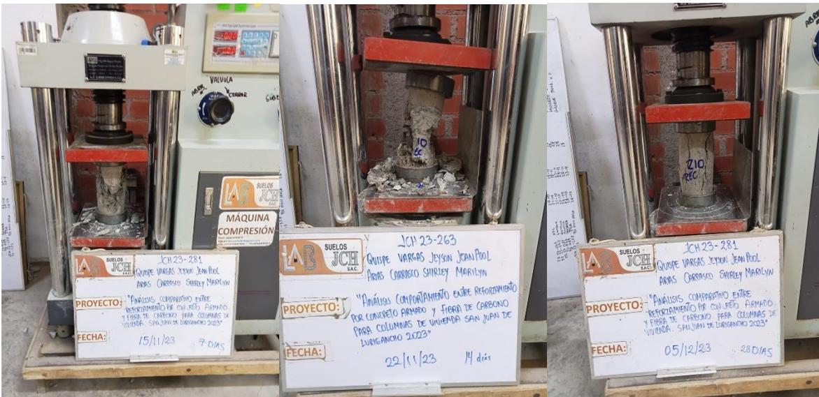
**ANEXO 19. Resistencia a compresión del diseño del concreto 175 kg/cm<sup>2</sup> con fibra de carbono y 210 kg/cm<sup>2</sup> para concreto armado.**
