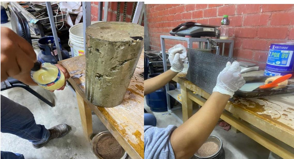
**ANEXO 22. Proceso de reforzamiento a los 7 días, con fibra de carbono para 1,2 y 3 capas, de mismo modo se realizará para las probetas de 14 y 28 días, con el aditivo Universal mezclando el tipo A+B}**
