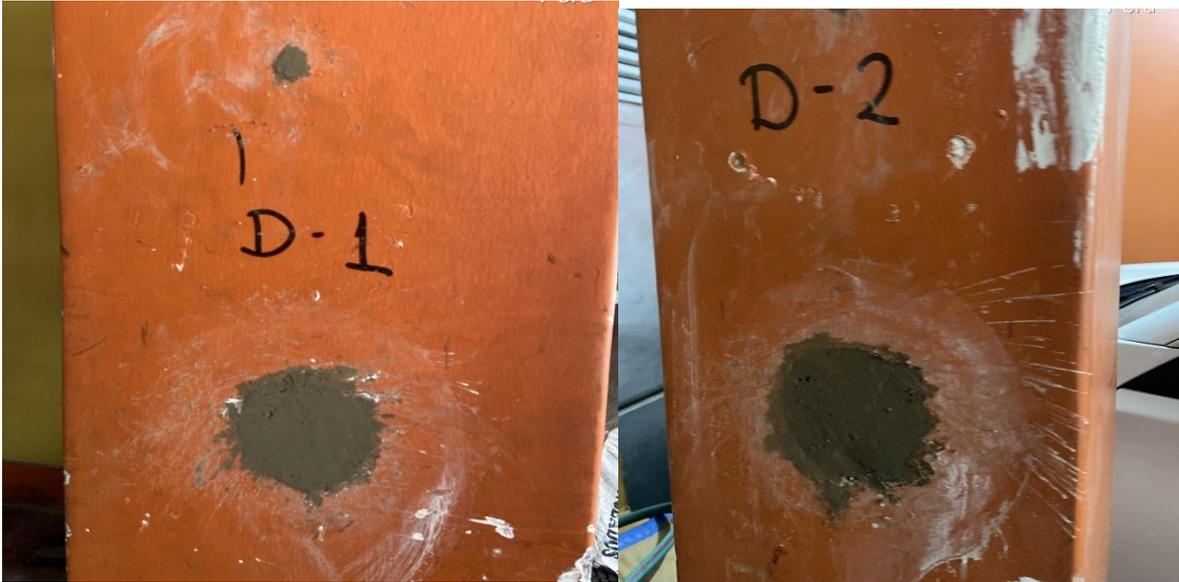
**ANEXO 6. Ensayo de diamantina de dos columnas de la vivienda existente**
