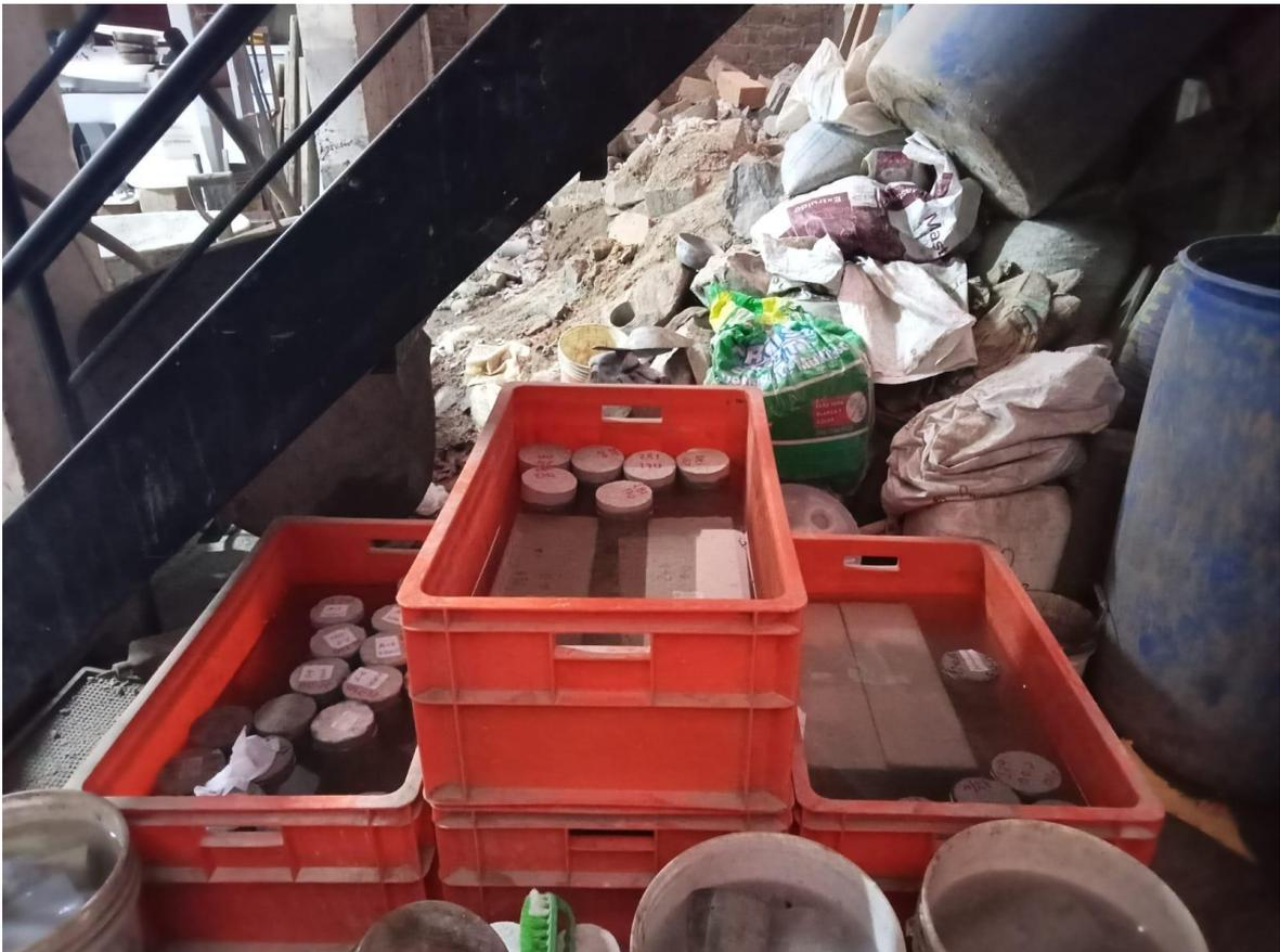
**ANEXO 14. 9 probetas del diseño de concreto de 210 kg/cm<sup>2</sup> y 18 probetas de 175 kg/cm<sup>2</sup> lo cual 9 probetas de 175 kg/cm<sup>2</sup> serán reforzadas con fibra de carbono.**
