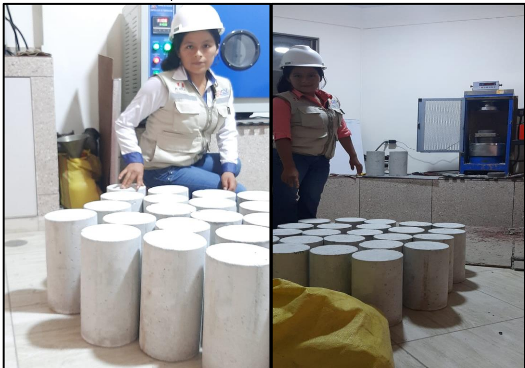
Probetas tipo cilindro de 28 días de edad
