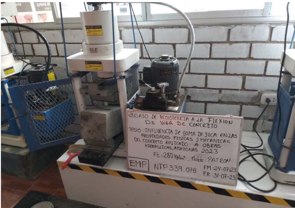
FOTO N° 06: Ensayo de rotura de probetas rectangulares para determinar la resistencia a la flexión.
