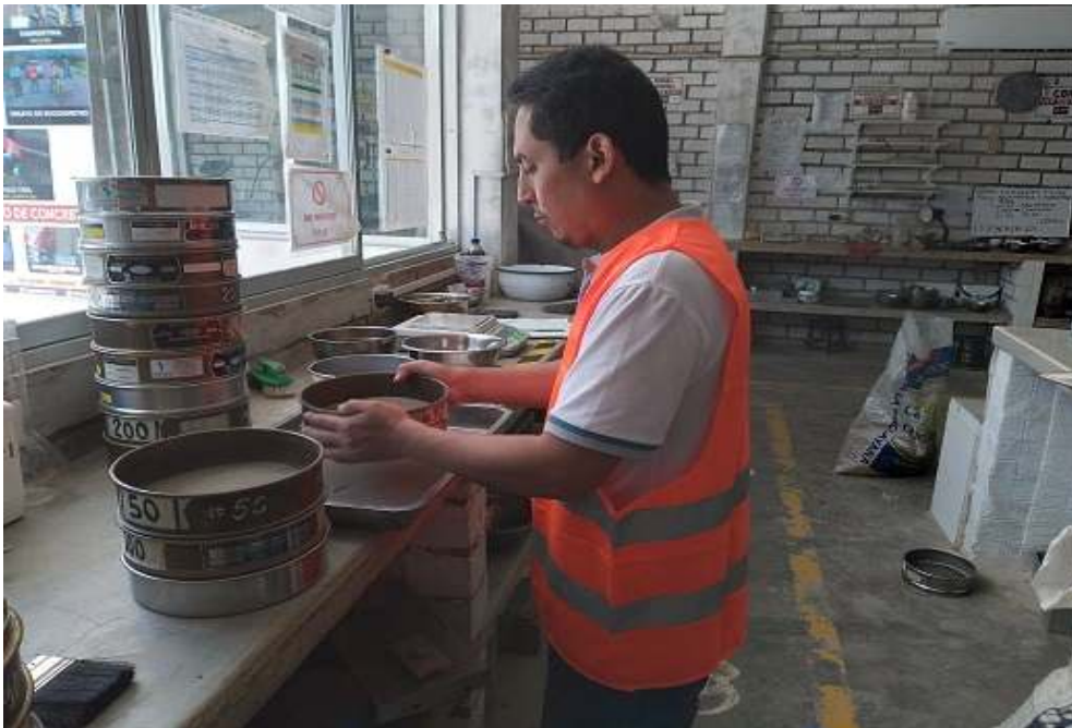
FOTO N° 01: Se observa la realización del tamizado de los agregados.
