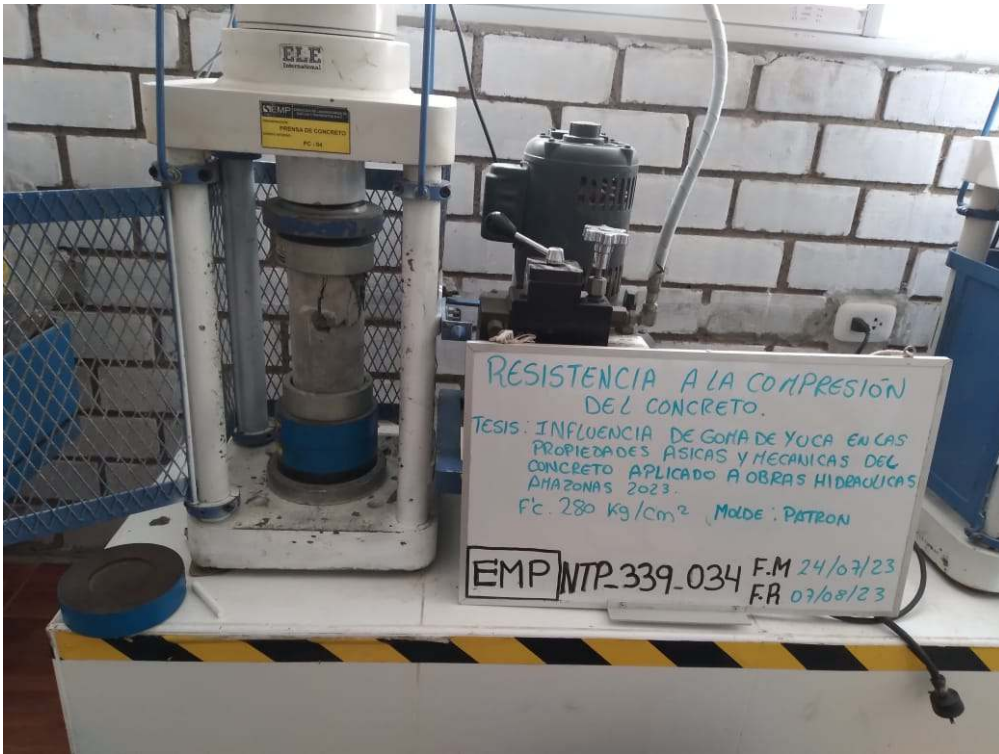
FOTO N° 05: Ensayo de rotura de probetas cilíndricas para determinar la resistencia a la compresión.
