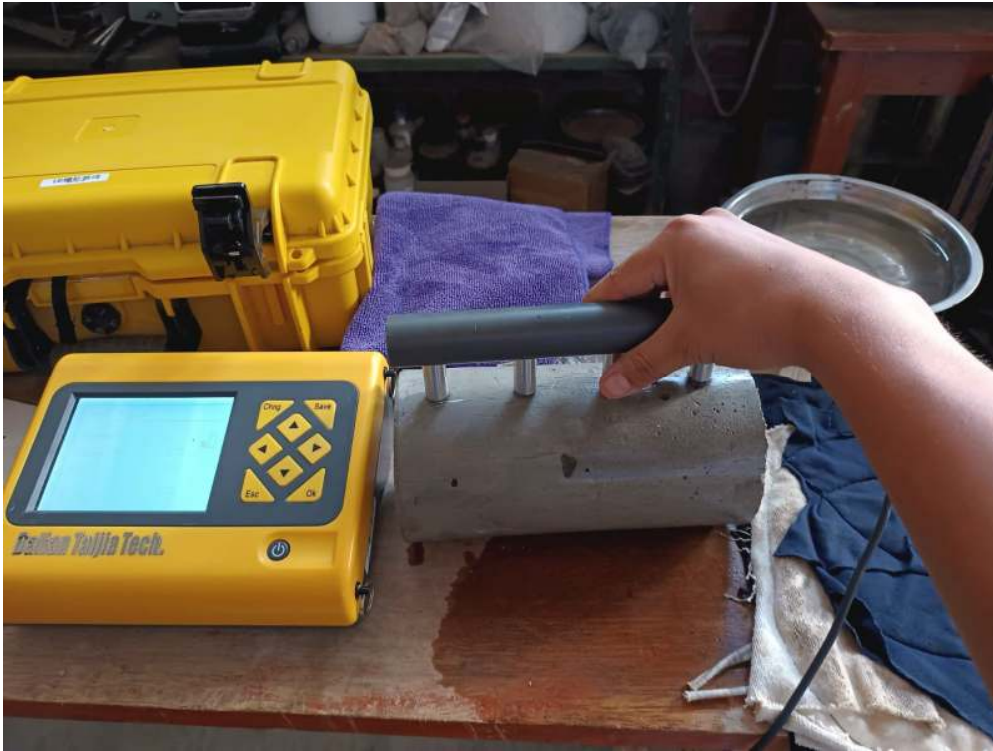
FOTO N° 07: Ensayo de resistividad del concreto.
