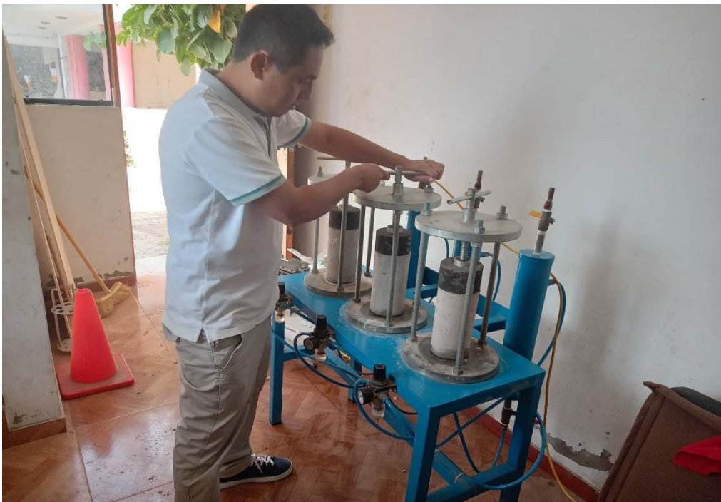
FOTO N° 08: Ensayo de permeabilidad del concreto.
