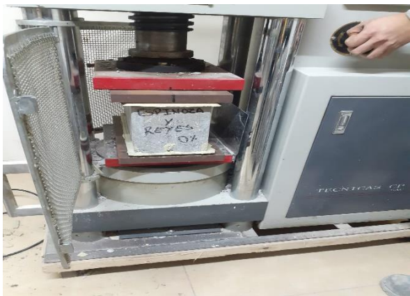
Ensayo a la compresión
