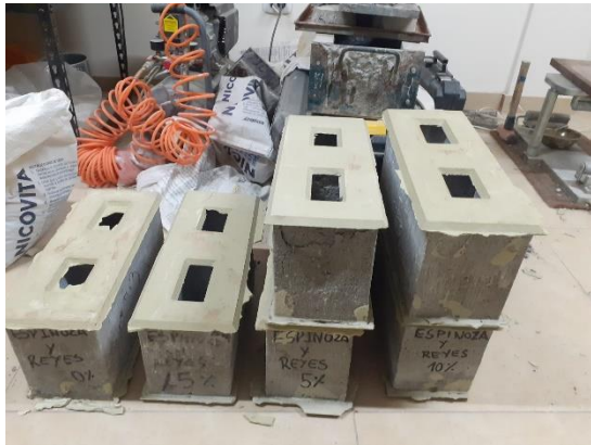
Ensayo a la compresión de los bloques
