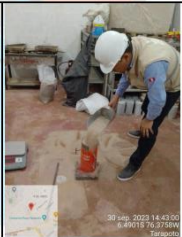
Fotos nº 11-12: En las imágenes podemos observar realización del ensayo de peso unitario.
