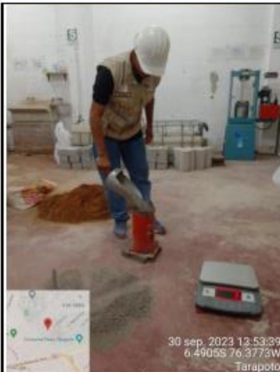
Fotos nº 13-14: En las imágenes podemos observar realización del ensayo de peso unitario.
