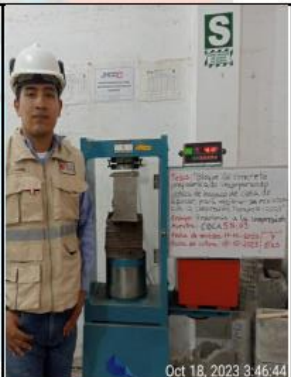
Fotos nº 15-16: En las imágenes podemos observar la resistencia a la compresión axial de los bloques de concreto.
