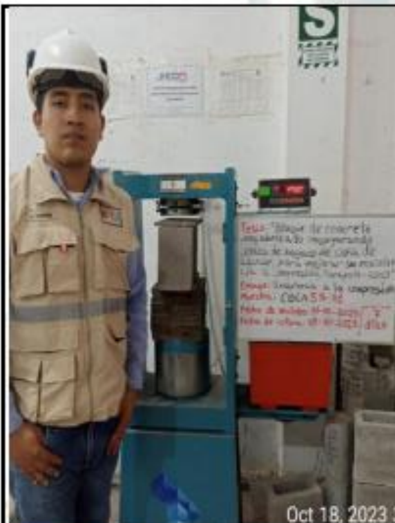
Fotos nº 15-16: En las imágenes podemos observar la resistencia a la compresión axial de los bloques de concreto.
