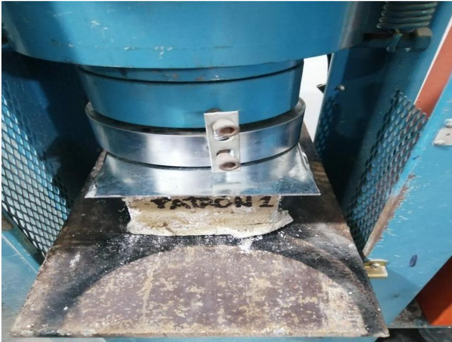
Prueba de Resistencia (adoquín patrón).
