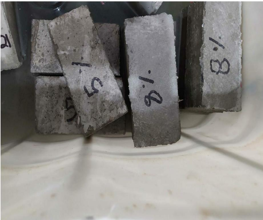
Adoquines de concreto con 3%, 5% y 8% de PET.
