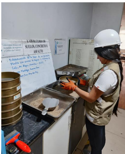
Figura 32. Tamizado del material granular para el analisis granulometrico
