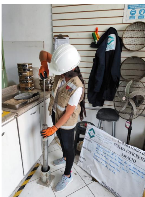
Figura 34. Compactación de muestra para el ensayo de Proctor Modificado
