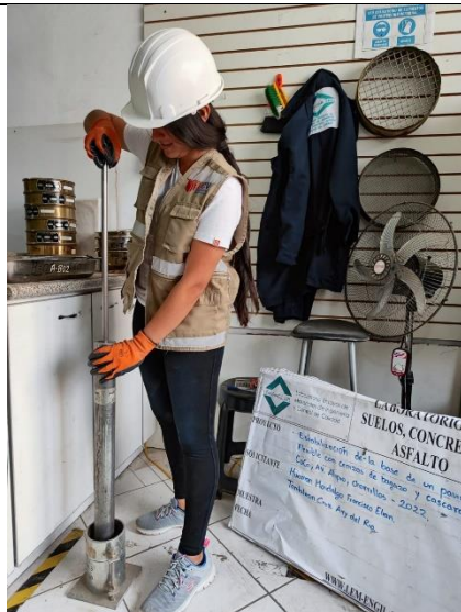
Imagen 23. Ensayo de Proctor 25 golpes con ayuda de un pisón.
