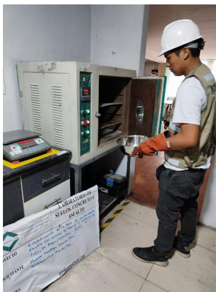
Figura 31. Secado en horno calibrado para el ensayo de contenido de humedad
