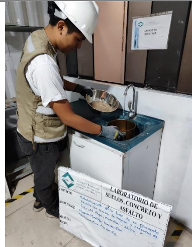
Imagen 20: Lavado de la muestra para hallar imite líquido y plástico.
