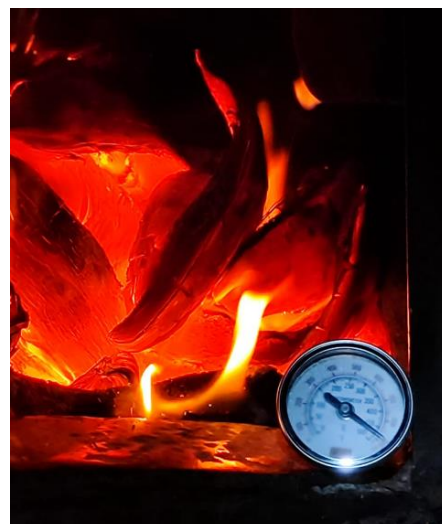
Figura 10. Calcinación de cascaras de coco en un rango de 400° – 500°.
