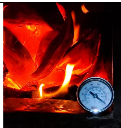
Imagen 6: Rango de temperatura a calcinar aproximado entre 400° – 500°
