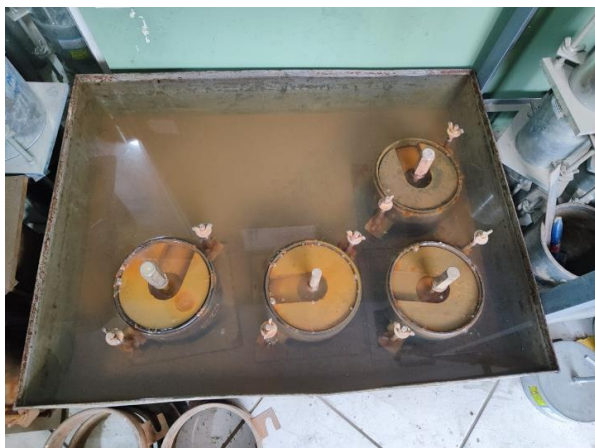
Figura 35. Saturación de moldes de CBR con las distintas dosificaciones
