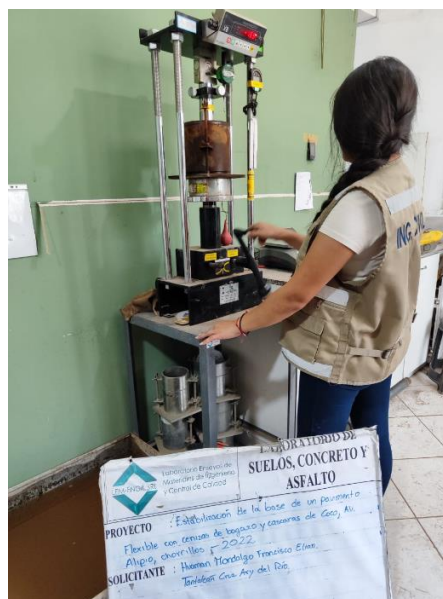
Figura 36. Ensayo de CBR
