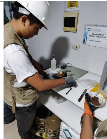
Imagen 22: Determinación de la plasticidad a través de la copa casa grande.
