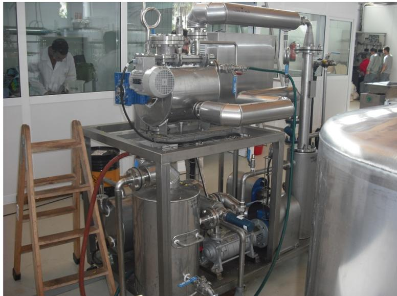
**Foto 3.4.** Equipo completo para la realización de *steam explosion* compuesto por reactor, bomba de aceite, sistema de refrigeración y sistema de control de presión y temperatura.
