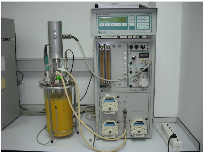
**Foto 3.5.** Bioreactor de 5L provisto de sistema de control Bio Controller ADI 1030.
