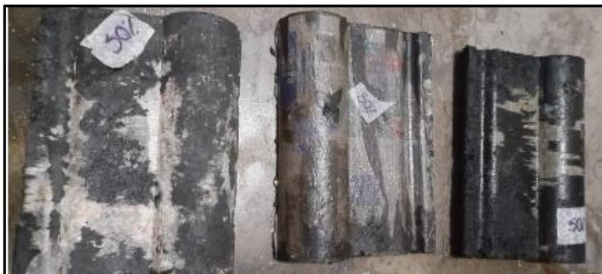
**Figura 12.** Diseño de mezcla C al 50% de neumático triturado
