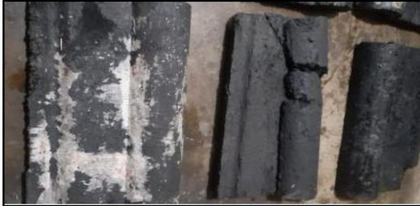
**Figura 10.** Diseño de mezcla A al 70% de neumático triturado
