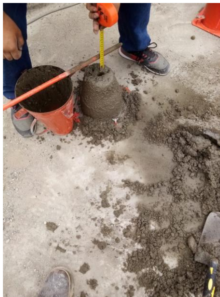
Figura 14. Slump del concreto con caucho 3%
