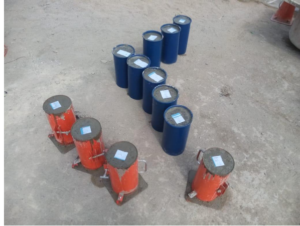
Figura 11. Probetas para ensayos de resistencia a la compresión
