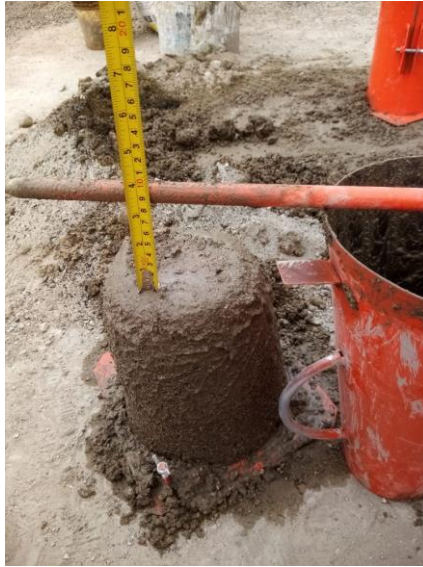
Figura 15. Slump del concreto con caucho 4%
