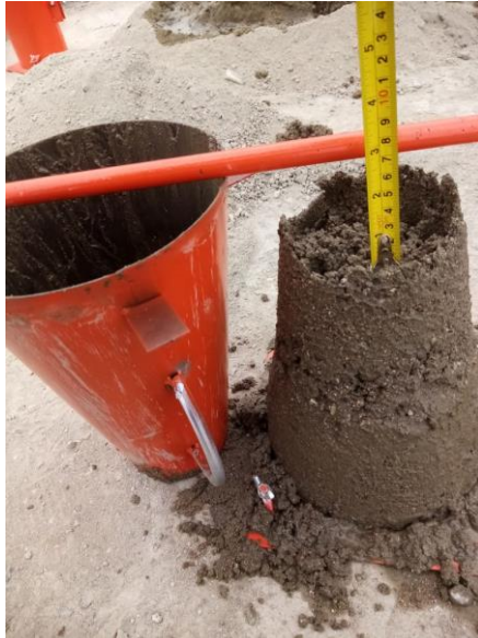
Figura 13. Slump del concreto patrón
