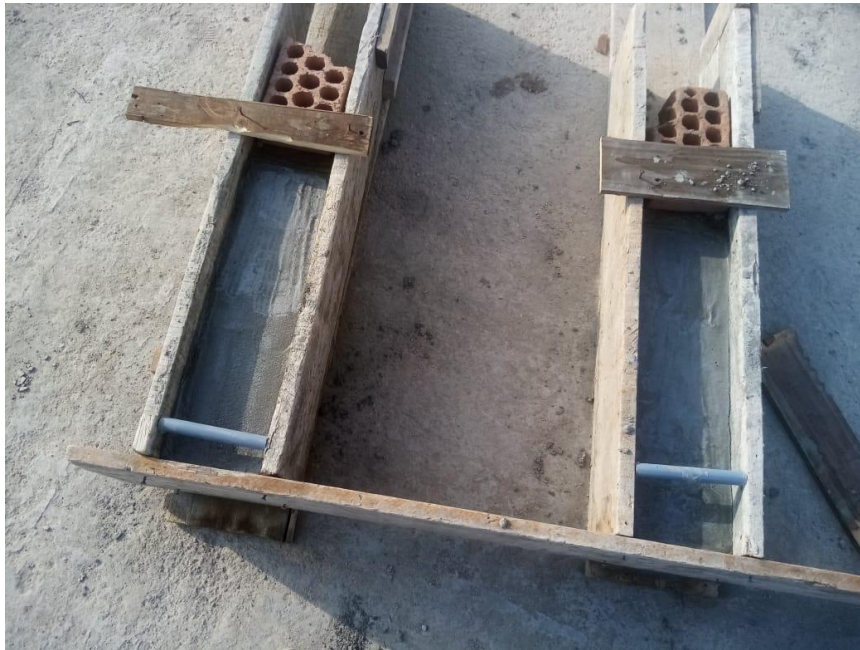
Figura 17. Encofrado de probetas para ensayos de resistencia a la flexión
