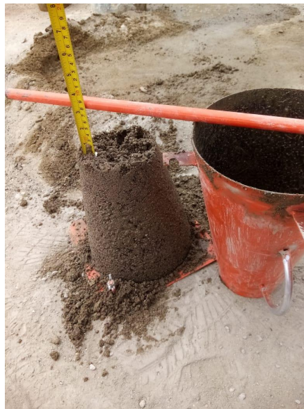
Figura 16. Slump del concreto con caucho 5%
