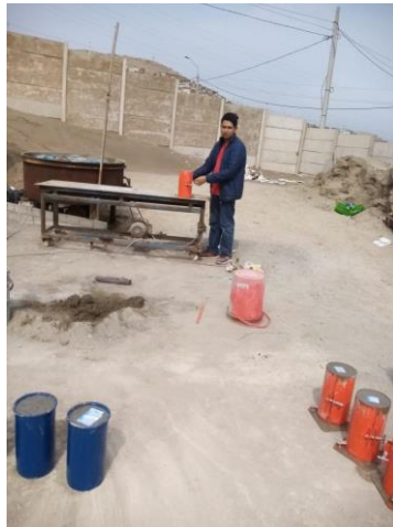
Figura 12. Probetas cilíndricas sometidas a vibración en mesa vibradora
