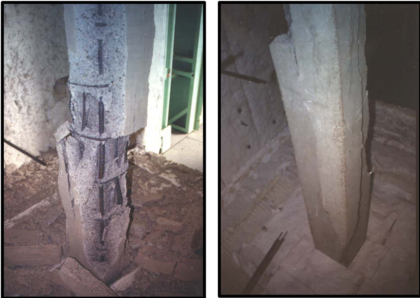
Fig. 6.3 Comparación entre el spalling de un pilar de HAR (izq.) y un pilar de HC (dcha.)
