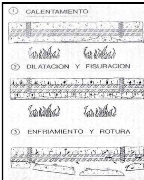
Fig. 5. 19 Efecto del calor sobre una estructura
