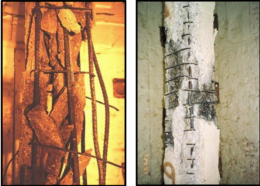
Fig. 6.5 Pilar de HAR con una disposición normal de estribos (izq.) y otro con una disposición modificada (dcha.)
