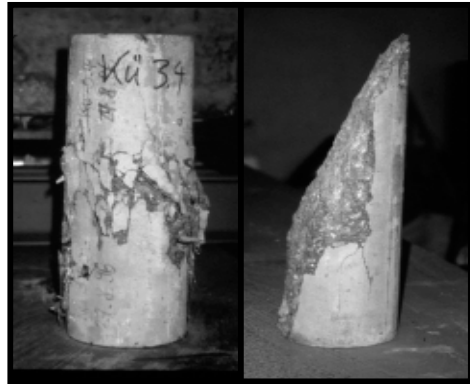
Fig. 8.4 Rotura de probetas de HAR con fibras (izq.) y sin fibras (dcha.)
