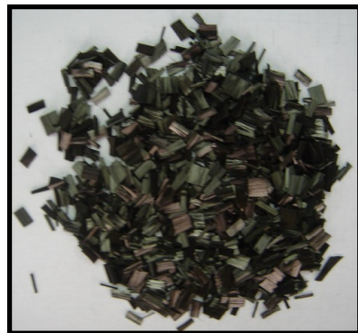
Fig. 5.25 Fibra sintética de carbono
