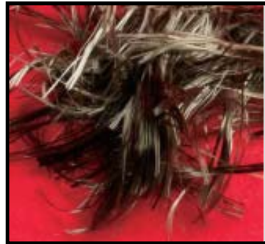
Fig. 5.27 Fibra inorgánica de basalto
