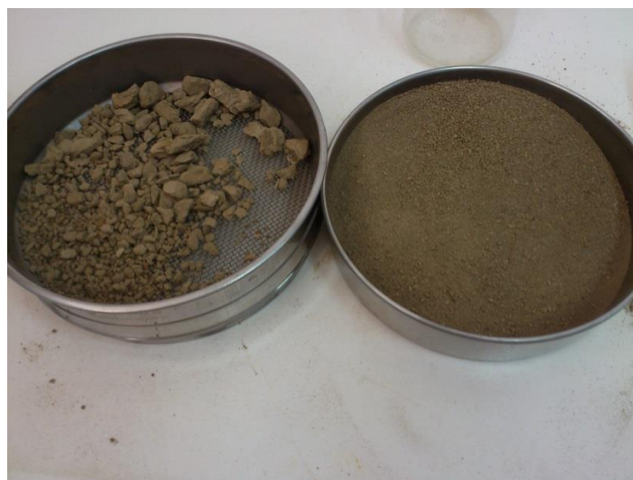
Imagen 18: muestra de suelo tamizada. A la izquierda partículas de tamaño grueso (superior a 2 mm) retenidas por el tamiz y a la derecha partículas de tamaño inferior a 2 mm.
