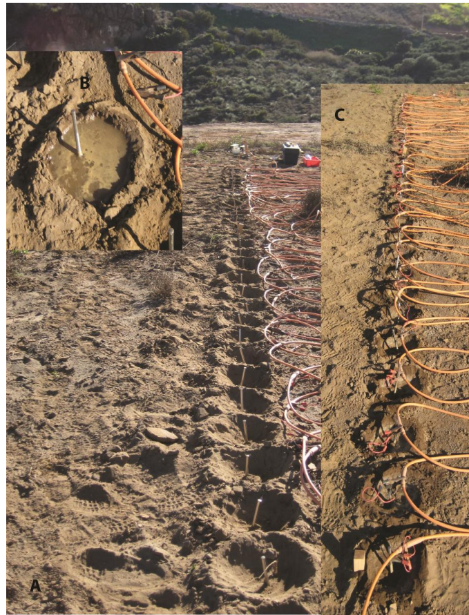
Imagen 11: preparación del suelo para la medición en húmedo. (11A: preparación de los pocillos; B: detalle de uno de los pocillos con el litro de agua; C estado final del suelo listo para la medición)
