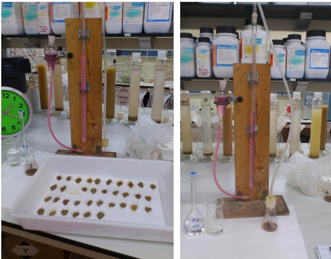
Imagen 23: detalle de la escala antes de desprenderse el \text{CO}_2 (izquierda) y después (derecha)
