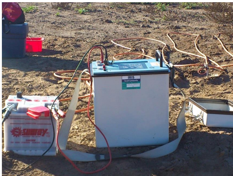
Imagen 7: equipo de Tomografía Eléctrica
