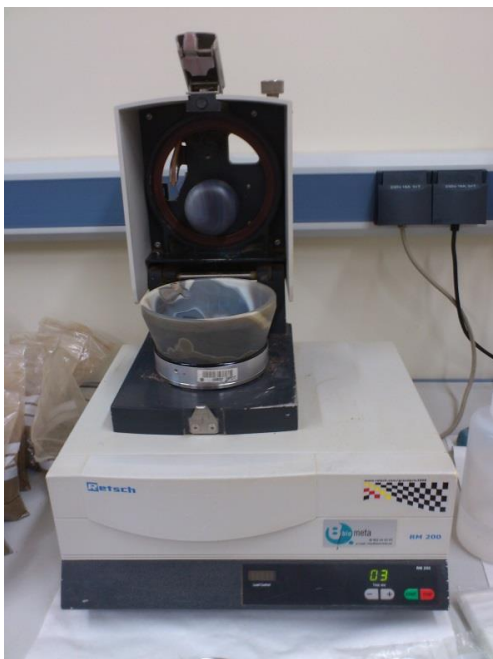
Imagen 20: a la izquierda el mortero automático y a la derecha una muestra de suelo triturado.
