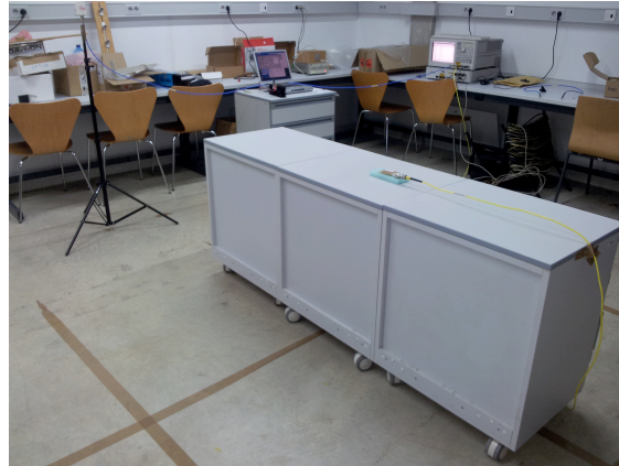
Figura 30. Escenario para medidas de referencia con la antena sobre la mesa
