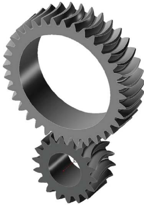
Figura 1.2.1: Modelo 3D de una transmisión de engranajes cilíndricos de dentado curvilíneo.
