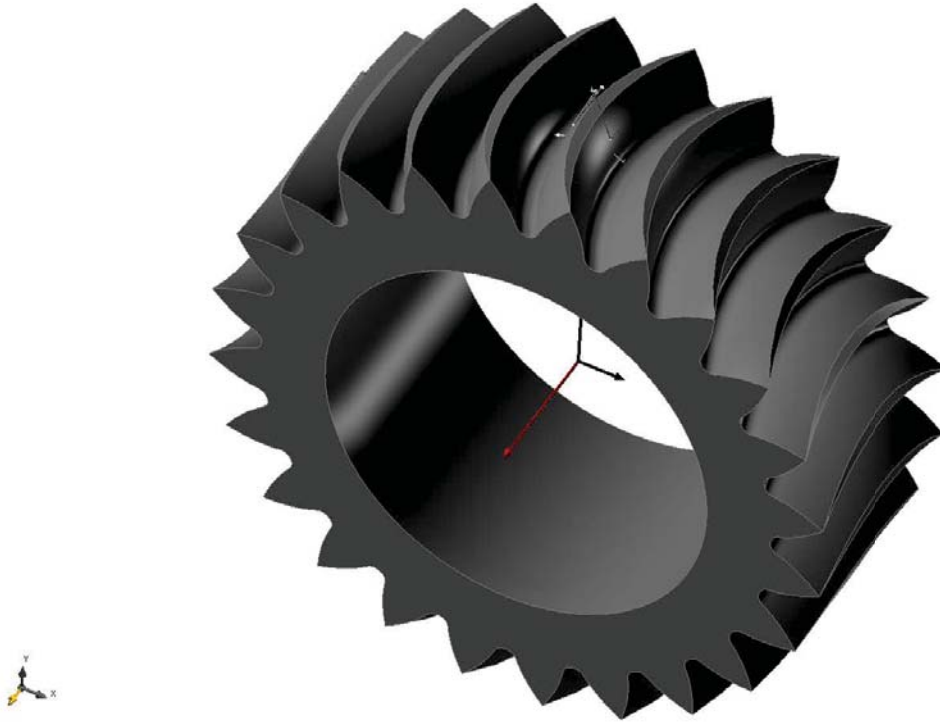
Figura 2.5.1: Detalle del efecto de apuntamiento sobre un engranaje cilíndrico-curvilíneo.
