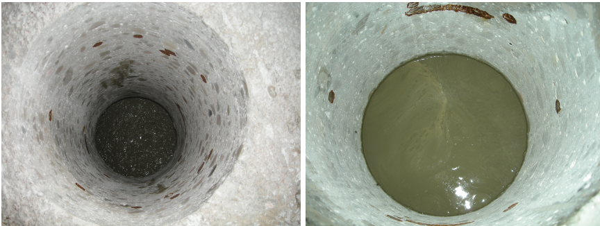
(a) Paso del HAC bajo la losa (b) Ascensión del HAC en un agujero cercano a la zona de hormigonado
