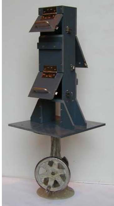
Figura 3.12 - Aparato del ensayo de la columna de consolidación (Rooney, 2002)
