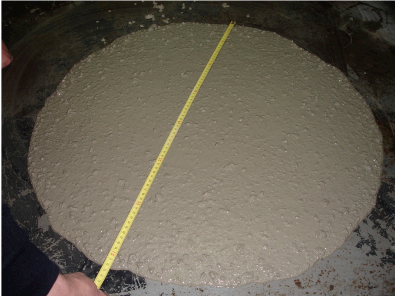
Figura 4.13 - Imagen de los ensayos de escurrimiento
