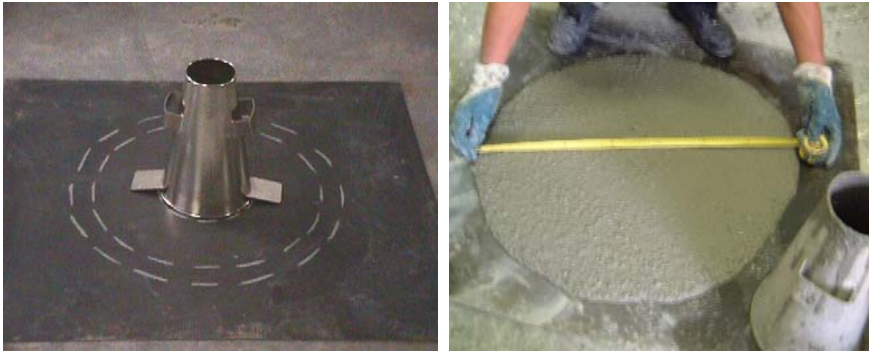
(a) Cono y base (b) Diámetro final de extensión
