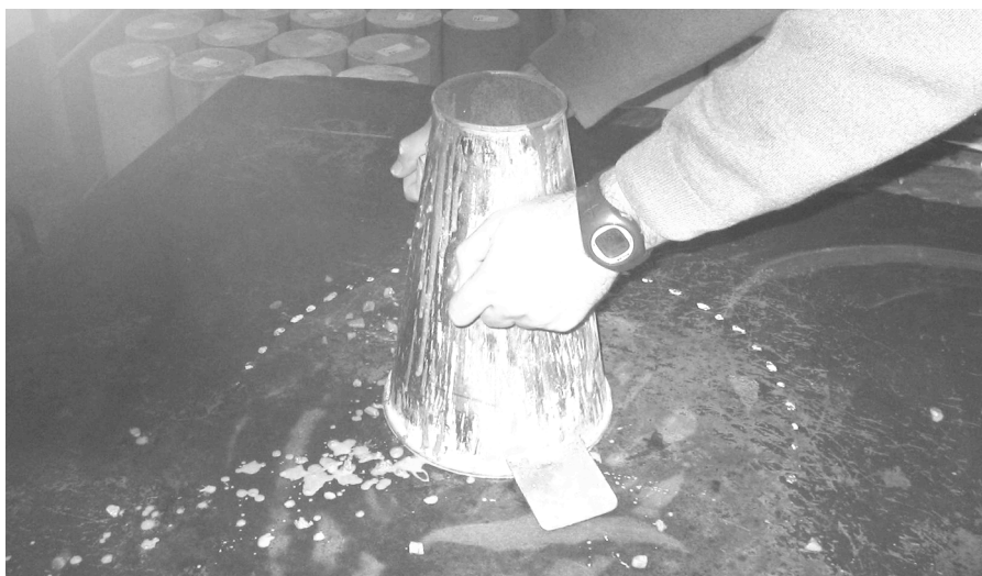
Figura 4.1 - Imagen del ensayo de slump flow
