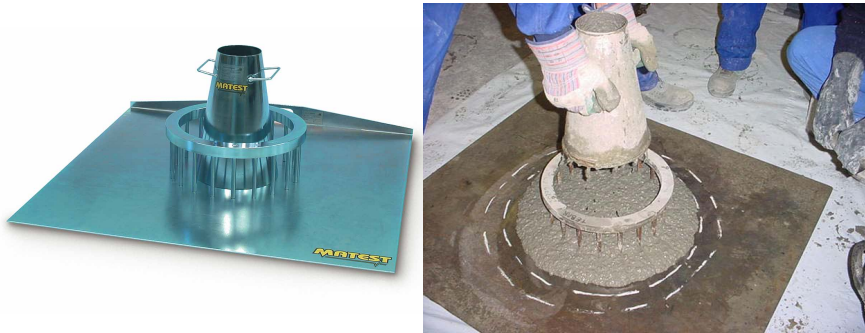
(a) Anillo de barras y cono de Abrams (b) Ensayo de extensión combinado con anillo
