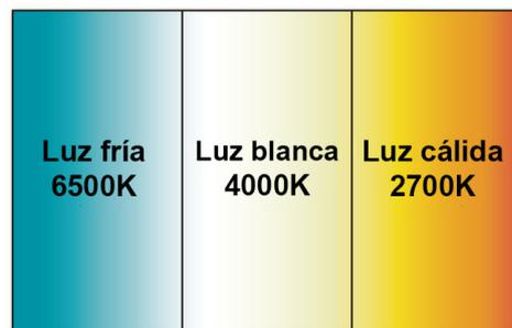
FIG 2.09- Representación cromática en función de los grados Kelvin
