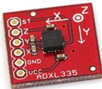
Figura 5.3: Acelerómetro analógico
