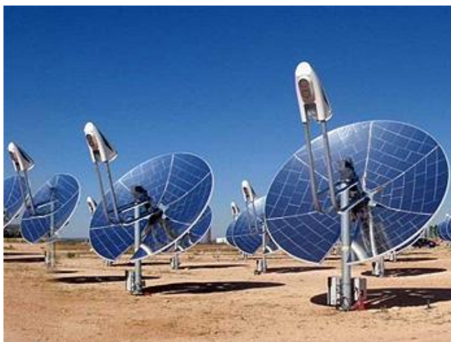
Figura 4. 45: Concentradores parabólicos con motores Stirling
