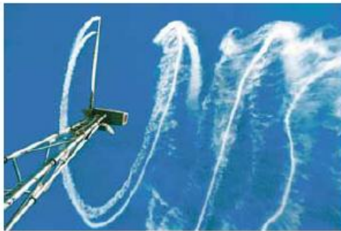
Figura 4. 54: Turbulencias provocadas por un aerogenerador (izquierda) y posicionamiento de aerogeneradores en una central de generación (derecha)
