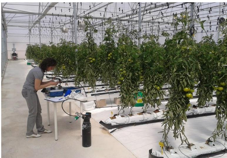
**Foto 7.** Equipo de medida del potencial de tallo, utilizando una cámara de presión: modelo 3000, Soil Moisture Equipment Corp., Santa Barbara, California, EEUU
