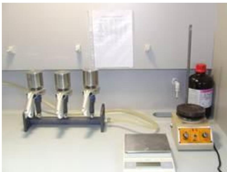
**Foto 6.** Sistema de filtración por membranas que se utiliza para la determinación de *E. Coli* y Coliformes Fecales
