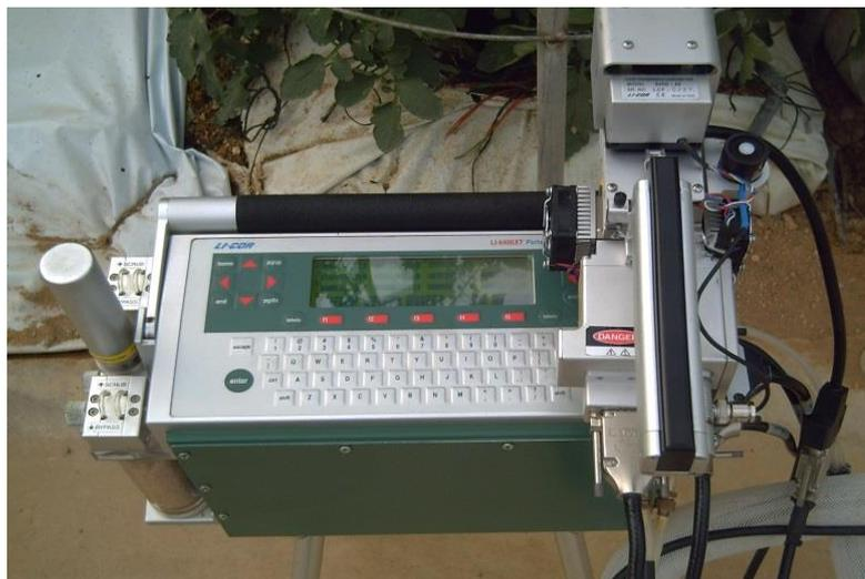
**Foto 8.** Equipo de fotosíntesis portátil: Li-6400, Li-Cor, Lincoln, NE, EE.UU.
