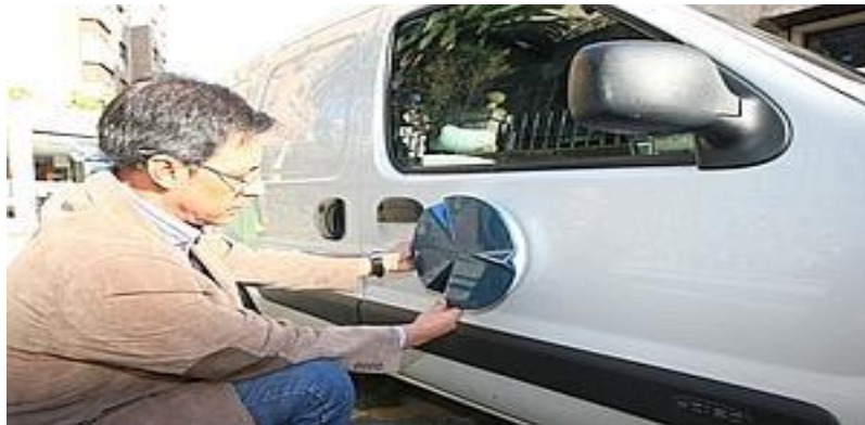
Figura 2.6.2.A. Instalación del dispositivo TrafikMeteor
