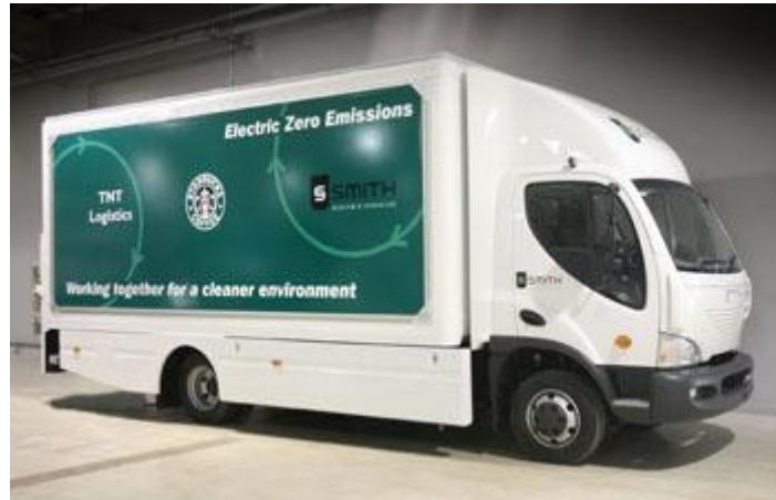
Figura 11.4. Camión eléctrico con autonomía de 250 km
