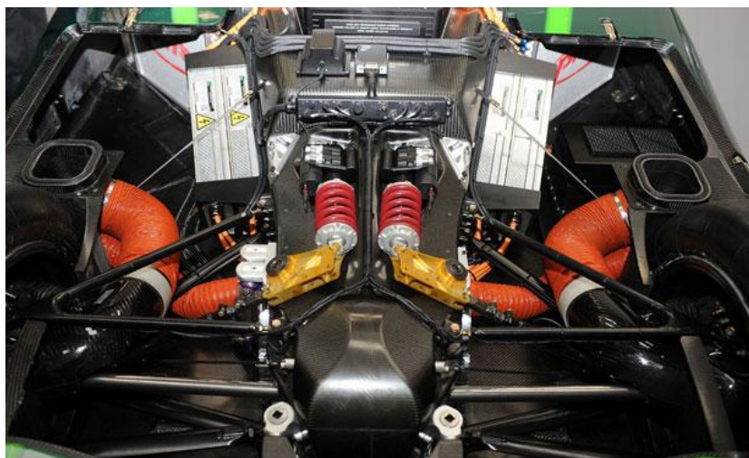
Figura 5.5.2.B. Sistema de recuperación de energía en la suspensión
