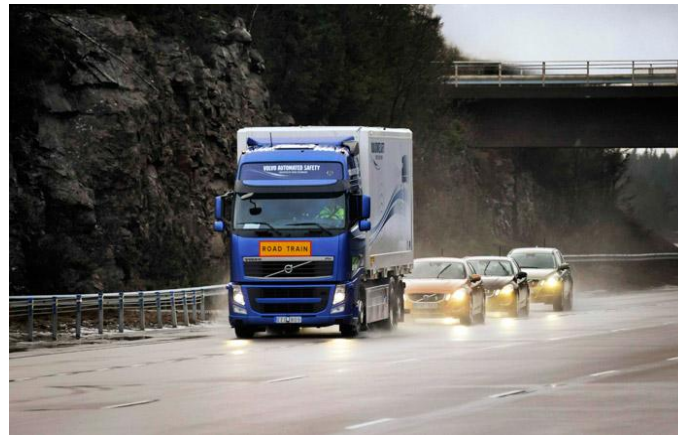
Figura 6.1.3. Pruebas de un convoy de tres vehículos dirigidos por un camión
