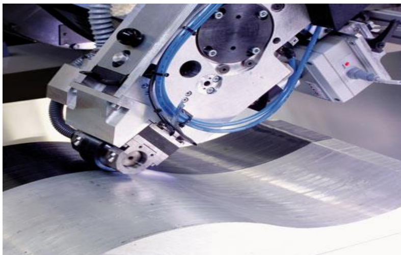
Figura 8.7.1.5. Soldadura por laser de las cintas de plástico reforzado con fibra de carbono
