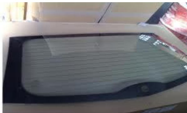
Figura 8.3. Lunetas anticondensación con nanotubos de carbono
