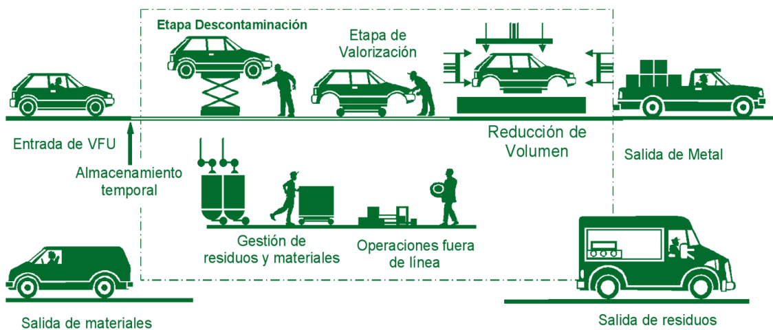
Figura 9.1.3. Esquema de funcionamiento de un CAT
