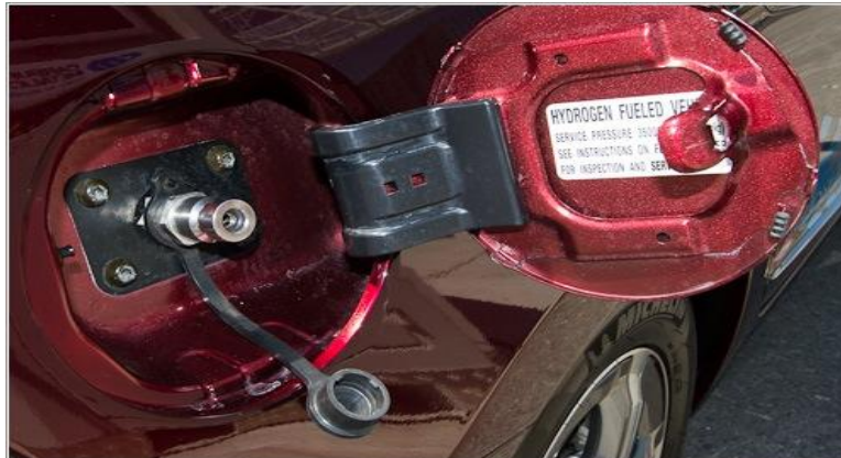
Figura 5.4.1.5.A. Dispositivo de carga de hidrógeno en un vehículo
