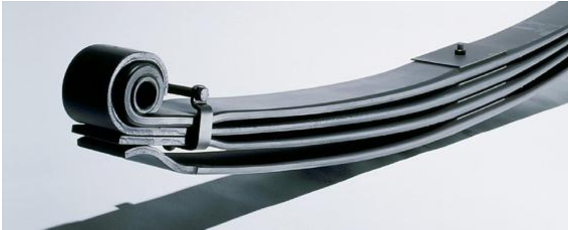
Figura 8.2.1.2. A Ballesta de la suspensión trasera de un camión
