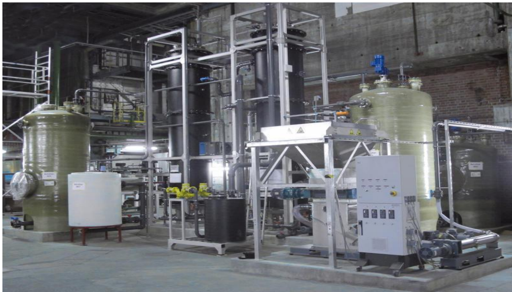
Figura 5.2.4. Planta piloto de biogás a partir de desechos alimenticios.
