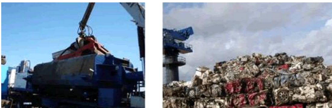
Figura 9.2.3. A y B Compactación de VFUs
