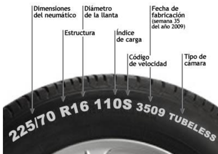
Figura 7.1.5. Especificación del tipo y características de un neumático
