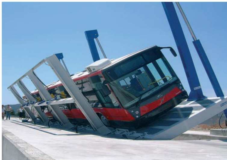
Figura 7.5. Ensayo de estabilidad a vuelco para autobuses
