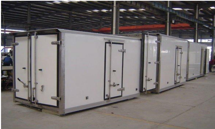
Figura 8.2.4. B. Cámaras frigoríficas para camión con paneles sandwich
