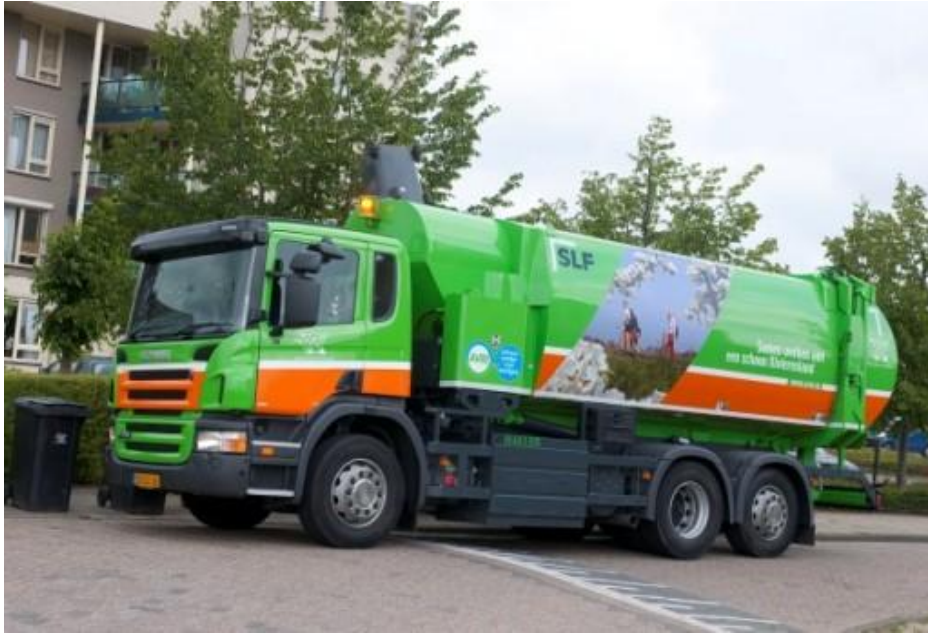
Figura 10.1.6.A. Camión SCANIA P310 con GNV y Metano
