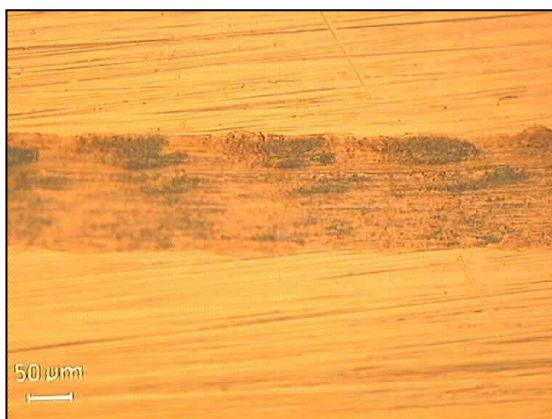
Imagen 126: Cuadrante inferior de huella tras el ensayo PAO6F3.
