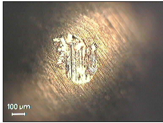
Imagen 99: Vista en punta del punzón tras ensayo PAO6C2, se observa huella.
