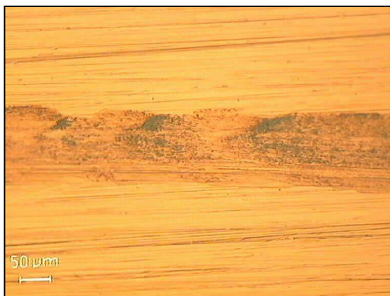
Imagen 128: Cuadrante superior de huella tras el ensayo PAO6F3.
