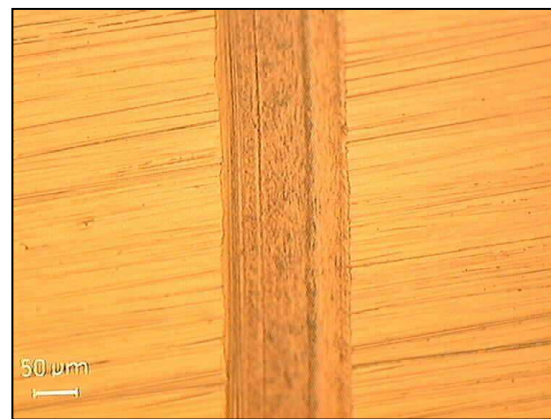
Imagen 129: Cuadrante derecho de huella tras el ensayo PAO6F3.
