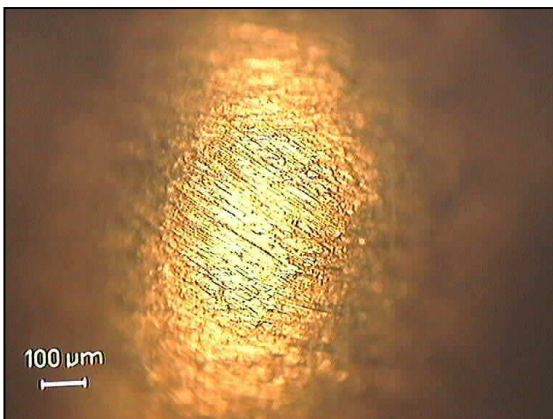
Imagen 122: Punta del punzón antes del ensayo PAO6F2.
