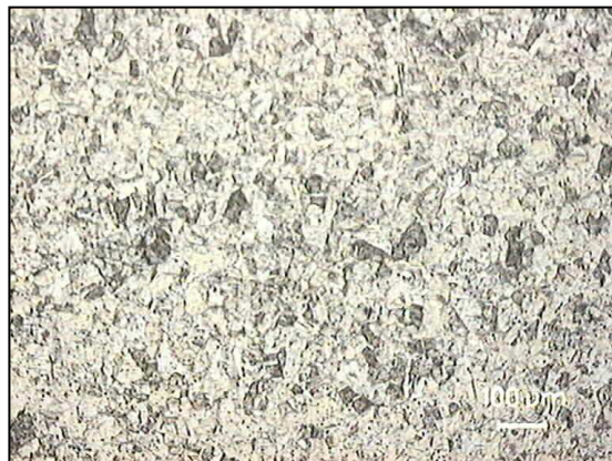
Imagen 73: Planta de Cu Compactado, aumento 10x.
