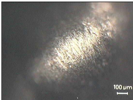
Imagen 106: Vista en punta del punzón del ensayo PAO6C3, antes del ensayo.
