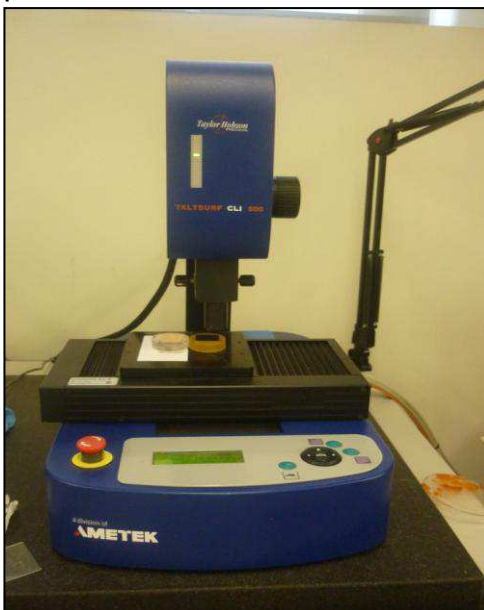
Imagen 64: Micro-perfilómetro de no contacto trabajando con dos probetas.
