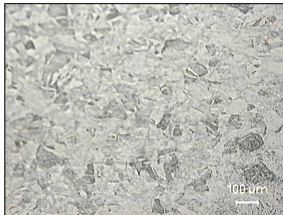
Imagen 80: Zona central del perfil de Cu compactado, aumento 10x.
