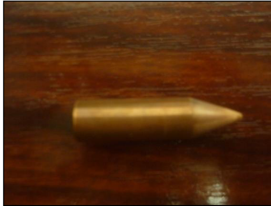
Imagen 63: Punzón tipo para los ensayos tribológicos Cu-Cu. Radio de la punta de 0,8mm.
