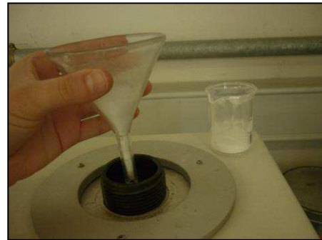
Imagen 49: Vertido de la poliamida termoplástica en la prensa de montaje.
