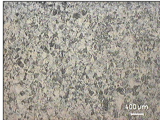
Imagen 72: Planta de Cu OFHC, aumento 2,5x.
