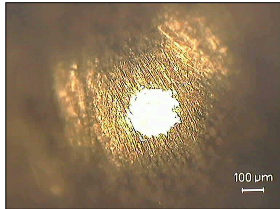
Imagen 197: Imagen de la huella en la punta del punzón tras el ensayo usando como lubricante LP-106.
