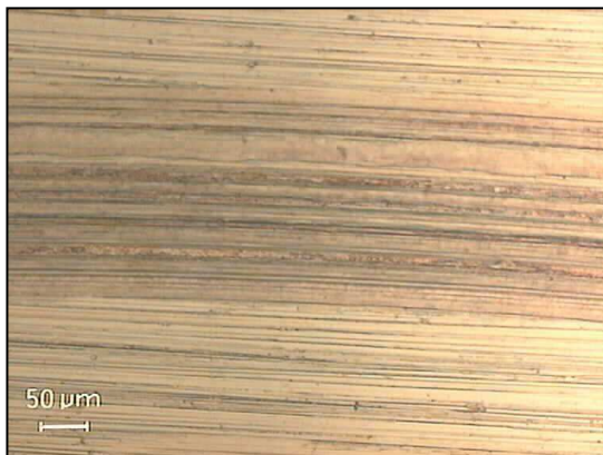
Imagen 96: Cuadrante superior huella en probeta tras ensayo PAO6C2.
