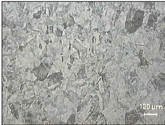
Imagen 71: Planta de Cu OFHC, aumento 10x.
