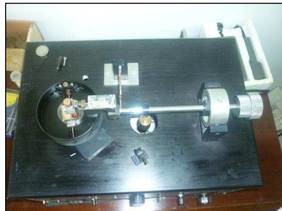
Imagen 61: Vistas del tribómetro trabajando con una probeta de cobre y punzón de cobre.
