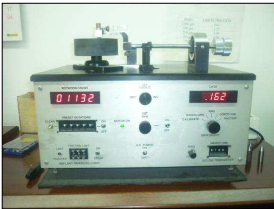
Imagen 61: Vistas del tribómetro trabajando con una probeta de cobre y punzón de cobre.
