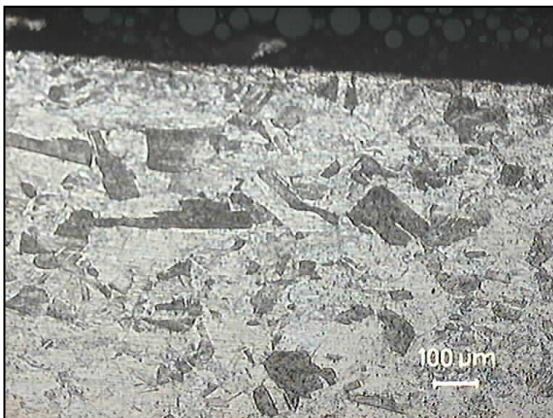
Imagen 77: Cu OFHC aumento 10x, vista de perfil cercano a extremo.
