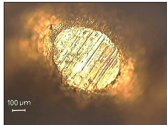
Imagen 107: Vista en punta del punzón tras el ensayo PAO6C3.
