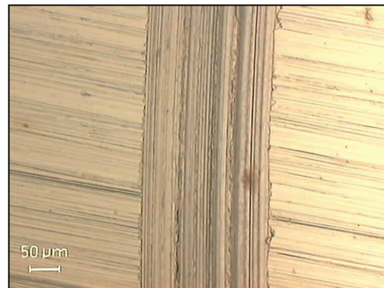
Imagen 97: Cuadrante izquierdo huella en probeta tras ensayo PAO6C2.
