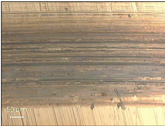
Imagen 88: Cuadrante superior de la huella producida en probeta durante el ensayo PAO6C1.
