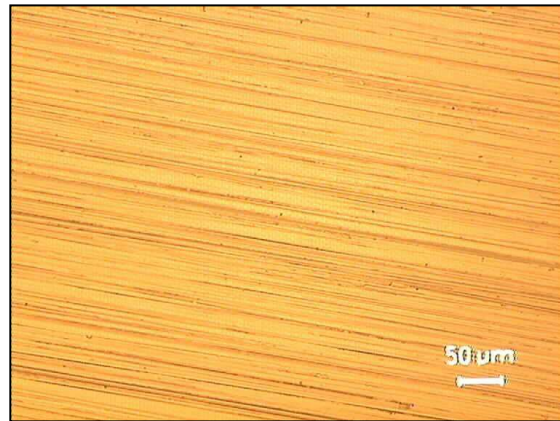
Imagen 166: Inexistencia de huella en otra zona de la misma probeta DAdC.
