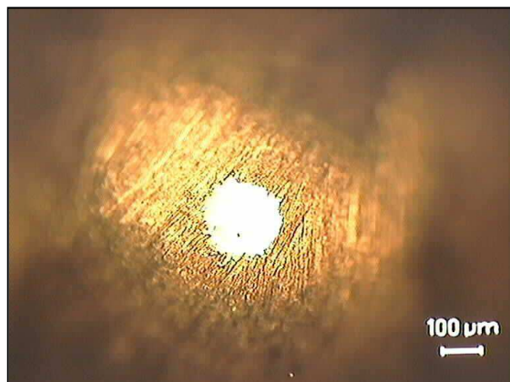
Imagen 168: Punta del punzón del ensayo DAdC después.
