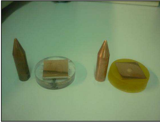
Imagen 84: Probeta compactada y elaborada en frío tras ensayo con sus respectivos punzones.
