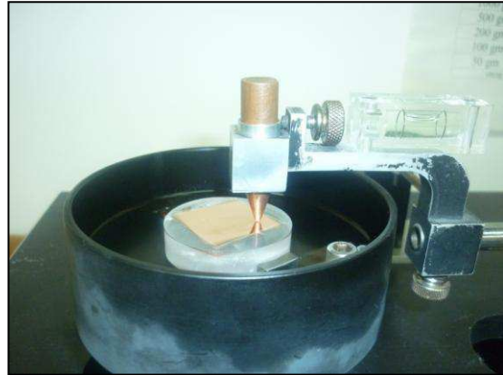
Imagen 85: Ensayo tribológico del contacto Cu-Cu en seco.
