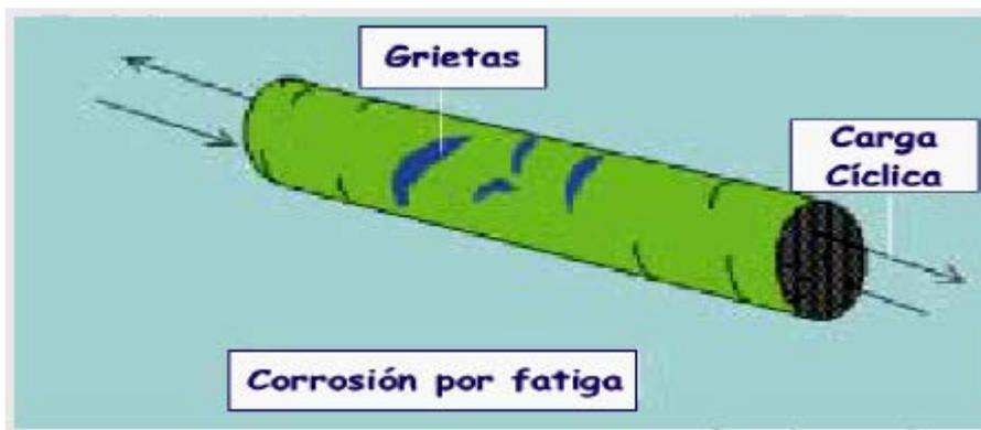
Fig.17: Corrosión por fatiga.
