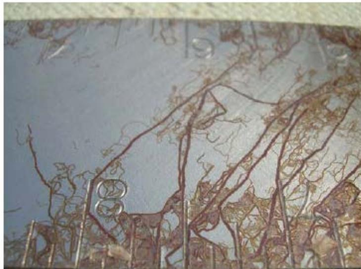
*Fig.10: Corrosión filiforme.*
