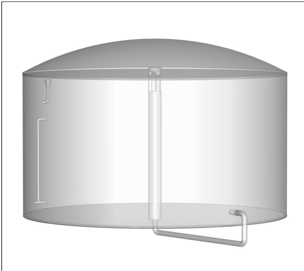
Figura 7.10. Diseño alternativo del tanque digester con una recirculación.
