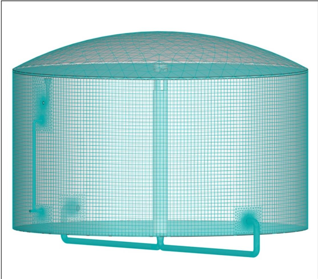
Figura 4.9. Mallado del volumen de control.
