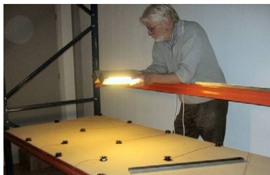
Figur 26. Drejning af lampehoveder i forhold til normal-positionen. Billedet viser, hvor lille vinkling der skal til, før blænding forekommer.
