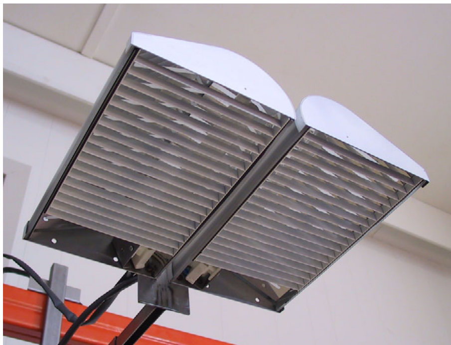
Figur 30. Sidste version af prototypen, hvor alle detaljer, som påvirker lampens lysfordeling, er blevet justeret ind. I den endelige prototype skal gitteret forløbe fra gavl til gavl.
