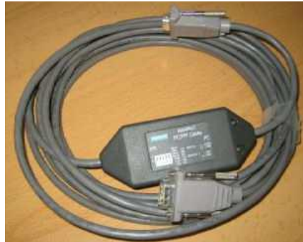
Figura 2.13. Cable de comunicación PI/PPI.
