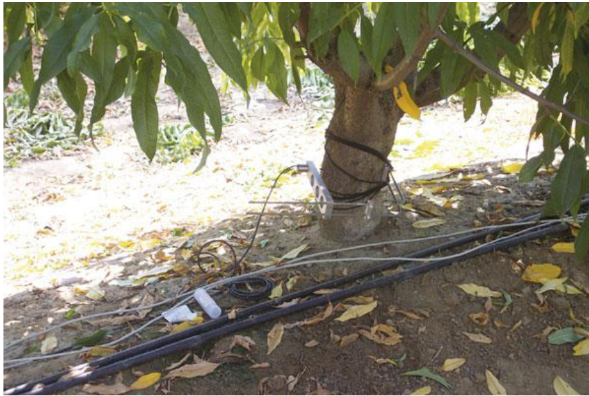
Figura 11. Sensor de dendrometría (LVDT).
