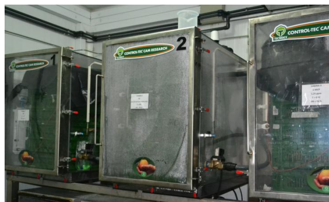
Figura 13. Cabinas herméticas para almacenamiento en atmósferas controladas (Control-Tec ® Cam Research-Tecnidex).
