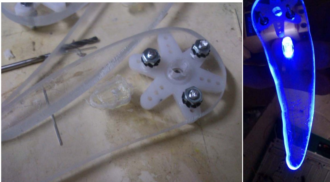
Figuras 6.5 y 6.6: Detalles de las patas: anclaje con las coronas de los servos y LED
