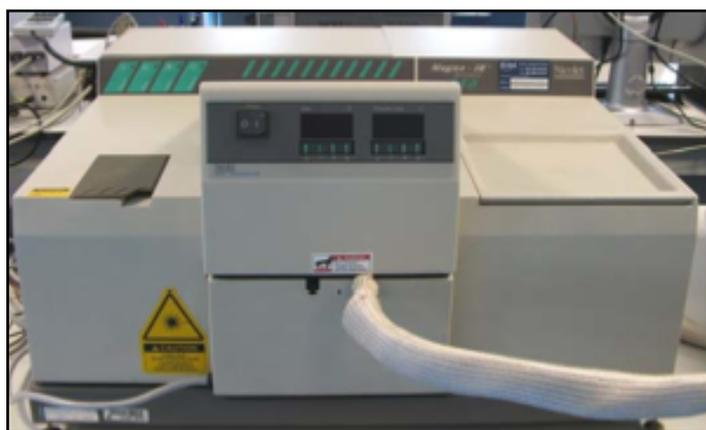
Figura 3.60. Espectrofotómetro FT-IR Nicolet Magna FT-550
