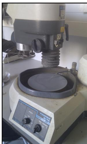
Figura 3.56. Pulidora metalográfica.
