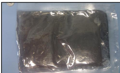
Figura 3.1. Nanotubos de carbono de pared múltiple.
