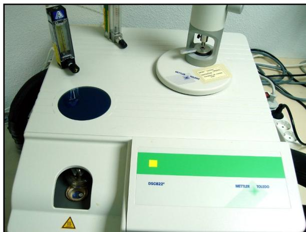
Figura 3.58. Calorímetro con detalle del horno.
