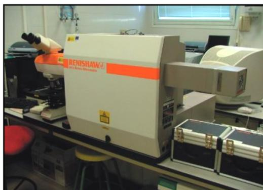
Figura 3.64. Espectrómetro de microscopía Raman.
