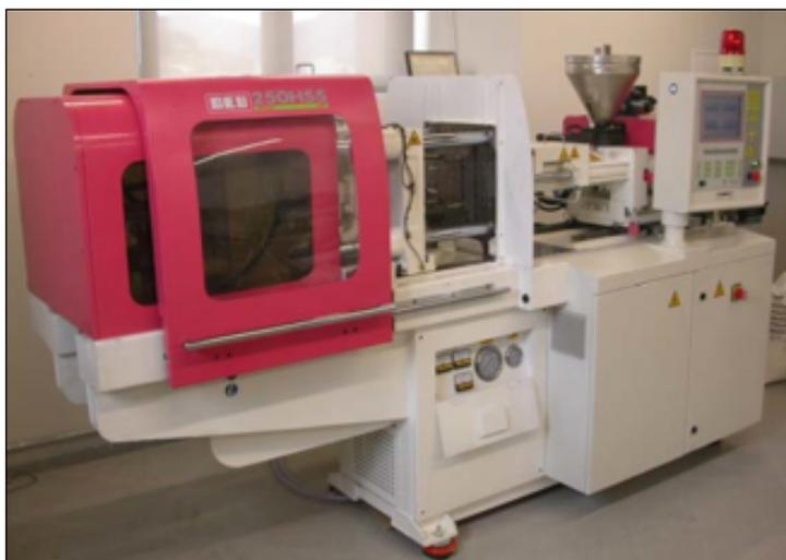
Figura 3.53. Máquina de inyección DEU 250 H55 mini VP.
