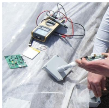
Figura 6.16. Fotografía del proceso de instalación de un nodo sensor.
