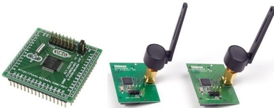
Figura I.28. Módulo de inserción MSP430-H1611 y kit de módulos de inserción CC2420EMK.
