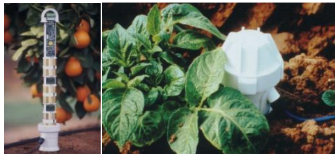
Figura I.11. Diferentes vistas del equipo EnviroSCAN.
