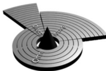
Figura I.15. Comparativa de antenas direccionales, omnidireccionales y sectoriales.
