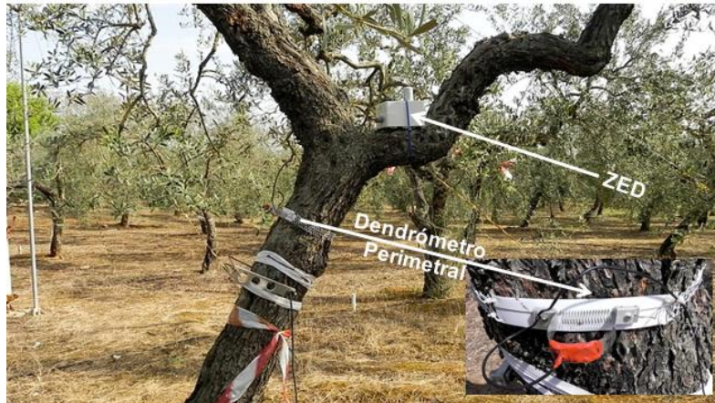
Figura 7.17. Uno de los dos ZED desplegados en la parcela de olivos.
