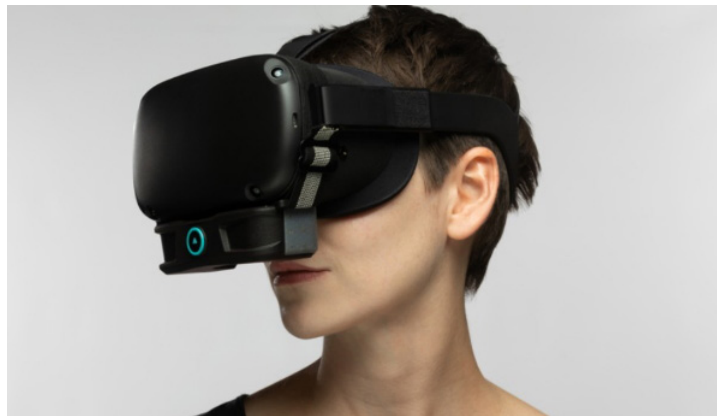
Le casque VR INHALE d'OVR Technology, qui intègre le sens de l'odorat à l'expérience de réalité virtuelle. Voir la fiche.
