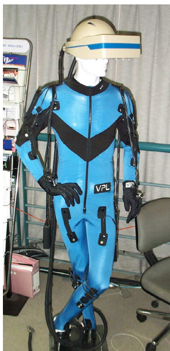
La combinaison DataSuit créée par VPL Research, mesurant les mouvements de tout le corps. Voir la fiche.
