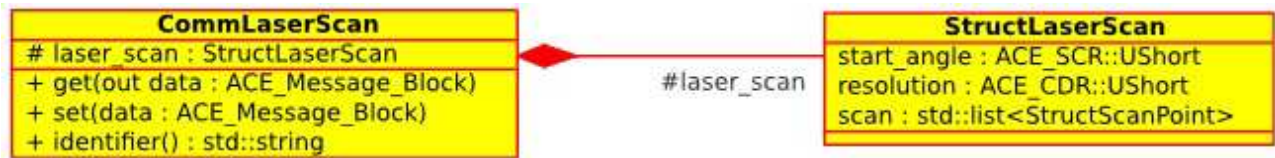
Figura 3.9: Interfaz del framework para el Objeto de Comunicación de un barrido de láser LaserScan
