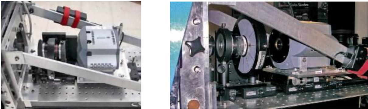
Figura 2.1. FastCam instalado en el foco Cassegrain del Telescopio Carlos Sánchez (1.5m) del Observatorio del Teide(OT)
