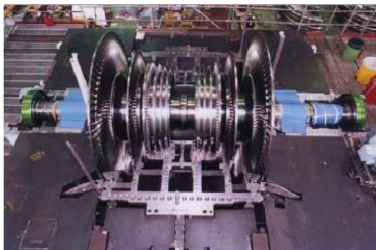
Figura 1.2.3.1: Turbina de vapor
