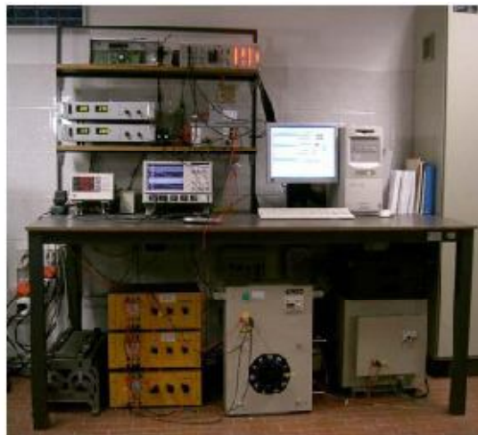
Figura 1.8.2.2.1: Imagen del banco de test anti-isla en el laboratorio de la Universidad de Bari
