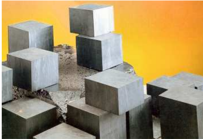
Bloques de silicio, materia prima para la fabricación de las células fotovoltaicas
