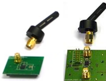
Figura 5.16: Módulos de radio CC2520 (imagen a la izquierda) y CC2591 (imagen a la derecha)
