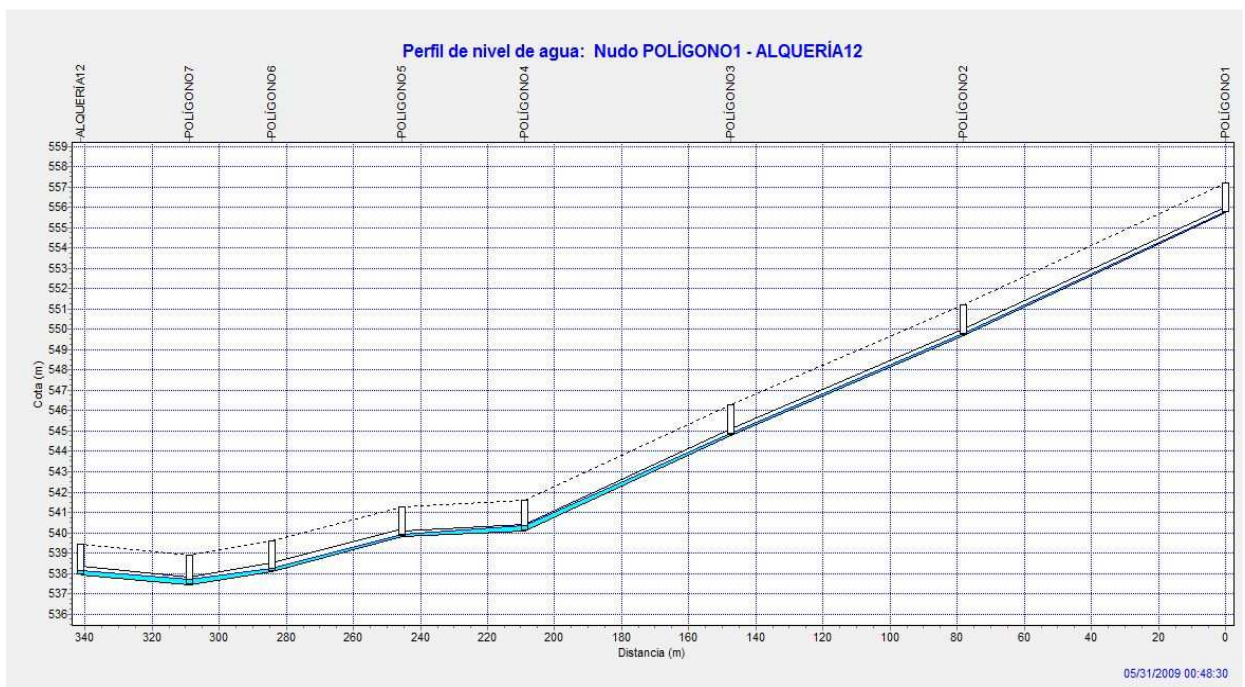
Gráfico 4. Perfil trazado Paraje El Santo para un caudal máximo a los 48 minutos y 30 segundos.
