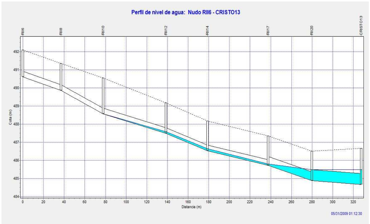
Gráfico 49. Perfil trazado R2-1 a la hora y doce minutos del comienzo de la lluvia para caudal máximo.
