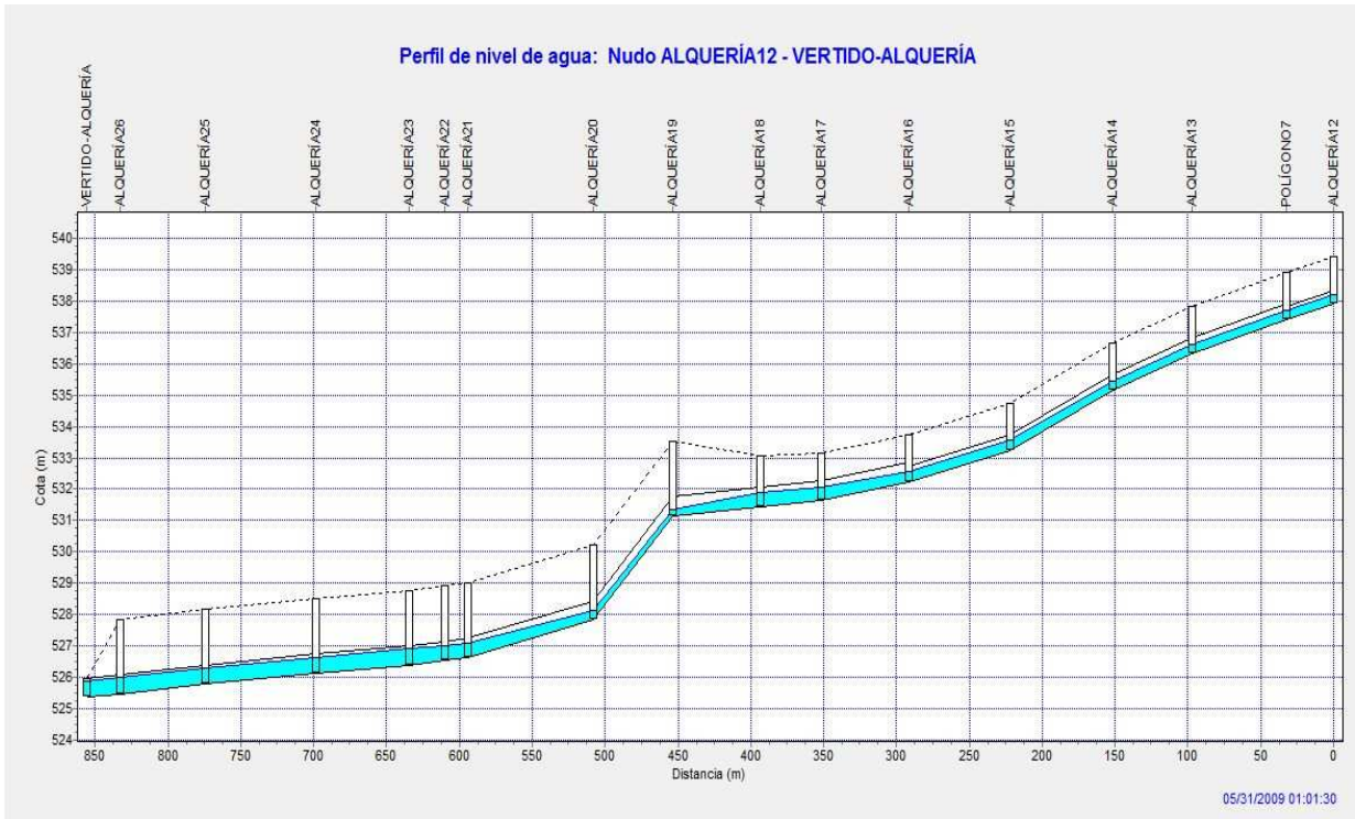
Gráfico 5. Perfil trazado Cerro del Castillo-Este en el tramo desde la rotonda de Avda. de Yecla hasta el punto de vertido en La Rambla de La Alquería para Q_{max} a la hora y un minuto.
