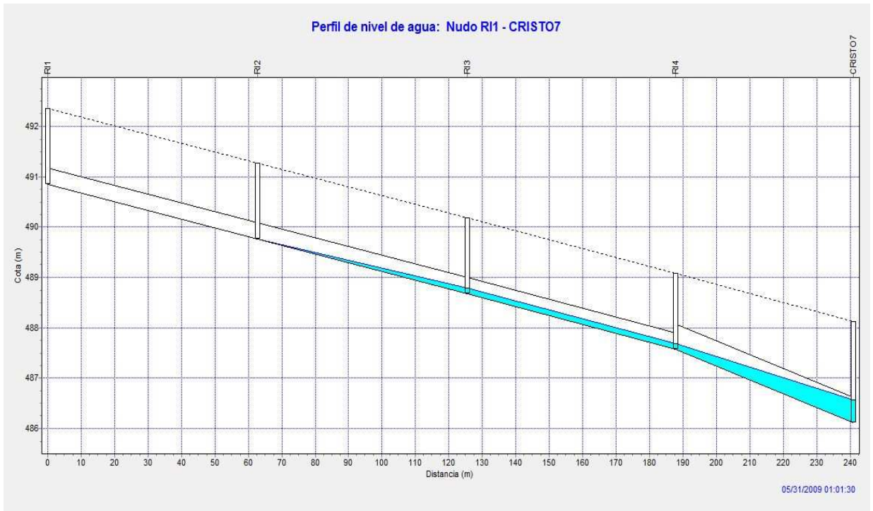
Gráfico 47. Perfil trazado R1-2 a la hora y un minuto del comienzo de la tormenta y para el caudal de diseño máximo.
