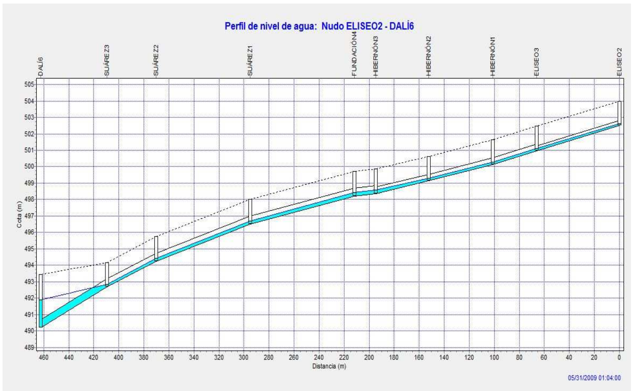
Gráfico 14. Perfil trazado SJ-4 a la hora y cuatro minutos donde existe el mayor caudal de paso por las conducciones.
