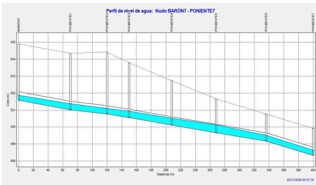
Gráfico 35. Perfil trazado CA-2 en su segunda parte desde el pozo BARÓN7 hasta el PONIENTE7 a caudal máximo de circulación.
