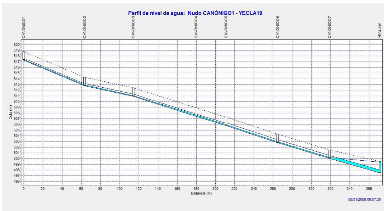
Gráfico 19. Perfil trazado NC-1 en el minuto 57 de la lluvia de diseño.
