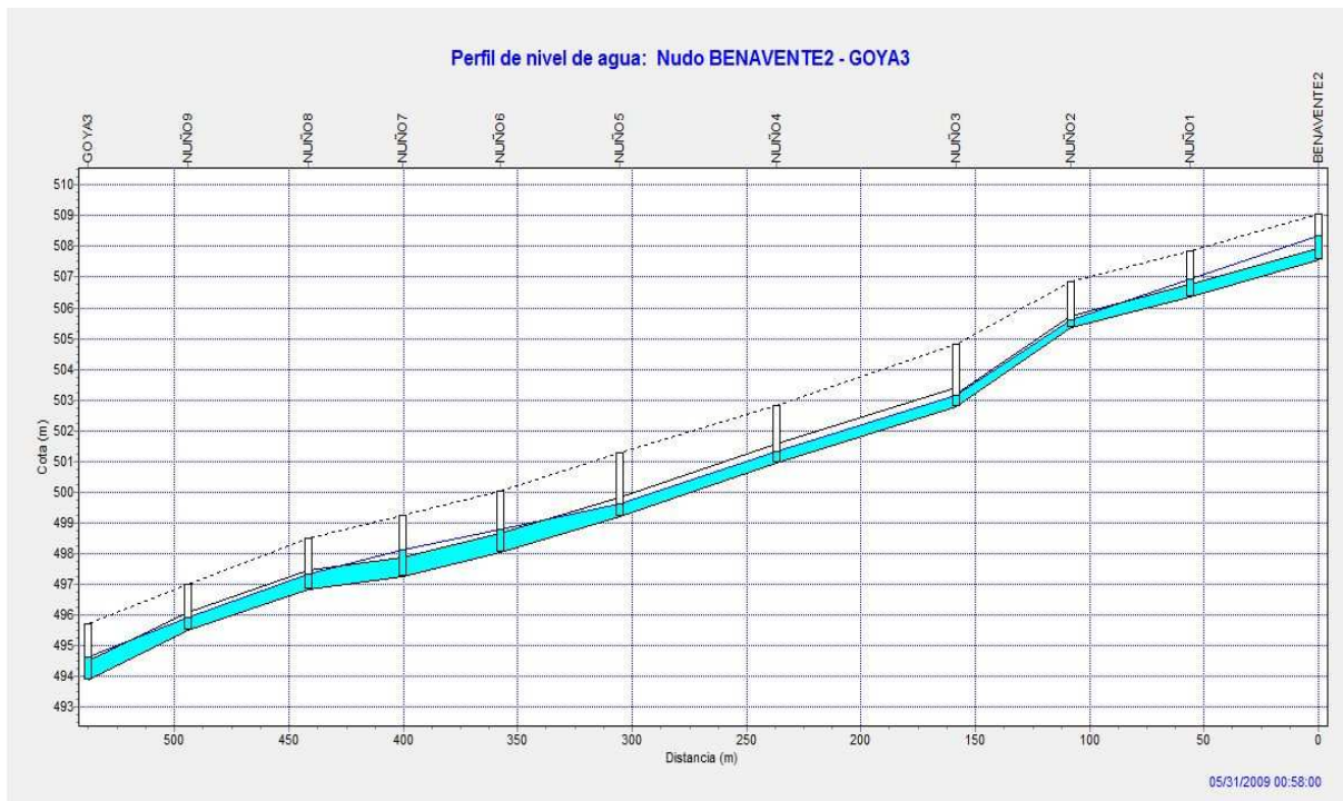
Gráfico 10. Perfil del trazado SJ-1 hasta calle Goya para los 58 minutos de lluvia.
