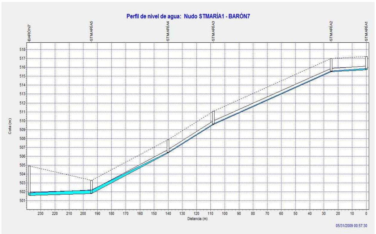
Gráfico 34. Perfil trazado CA-2 desde el inicio hasta el pozo BARÓN7 para los 57 minutos y 30 segundos del comienzo de la lluvia.
