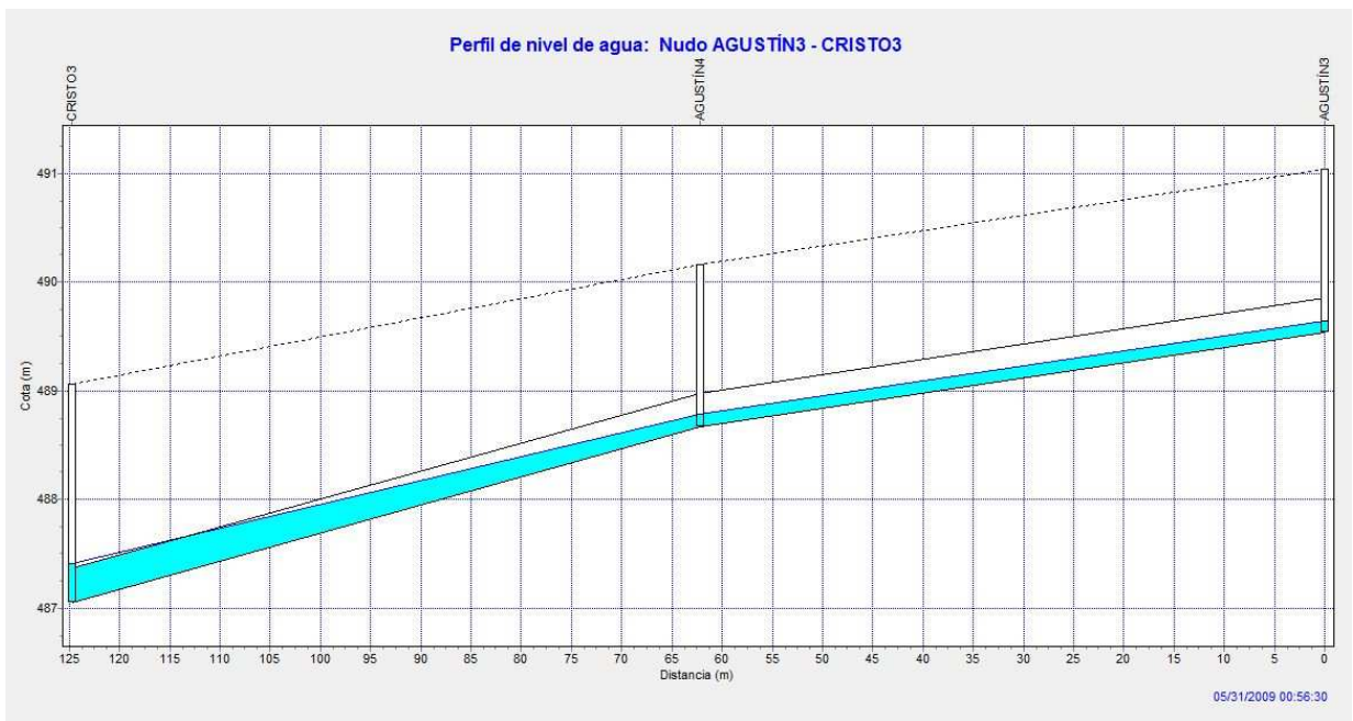
Gráfico 46. Perfil trazado R1-1 para el momento de caudal máximo a los 56 minutos del comienzo de la lluvia de diseño.
