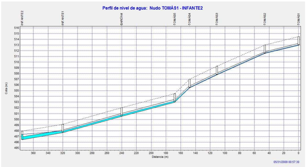
Gráfico 32. Perfil trazado CA-1 desde su inicio hasta el pozo INFANTE2 a los 57 minutos y 30 segundos del comienzo de la lluvia de diseño.
