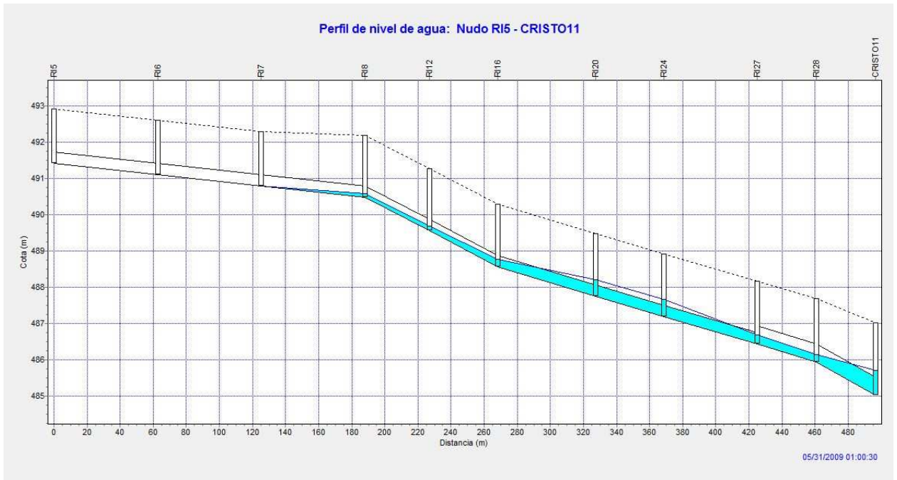
Gráfico 48. Perfil trazado R1-3 a la hora del comienzo de la lluvia de diseño para caudal máximo.
