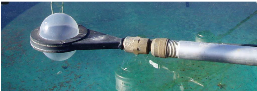
Figura 3.2.2. Sensor de radiación neta (REBS Q7.1-L).
