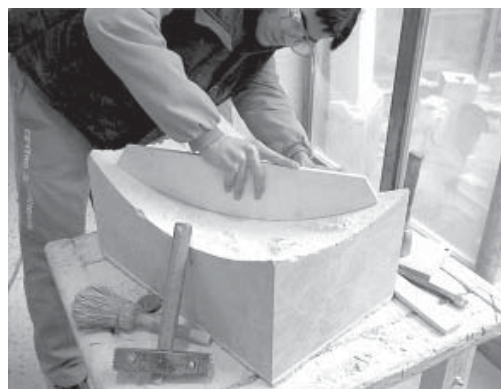
5.8. Materialización de la superficie esférica con la cercha.
