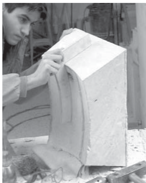
5.10. Labra de lechos y juntas con el baivel.
