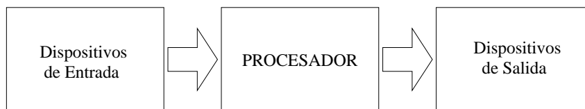
Figura 1.1: Estructura básica de una computadora.
