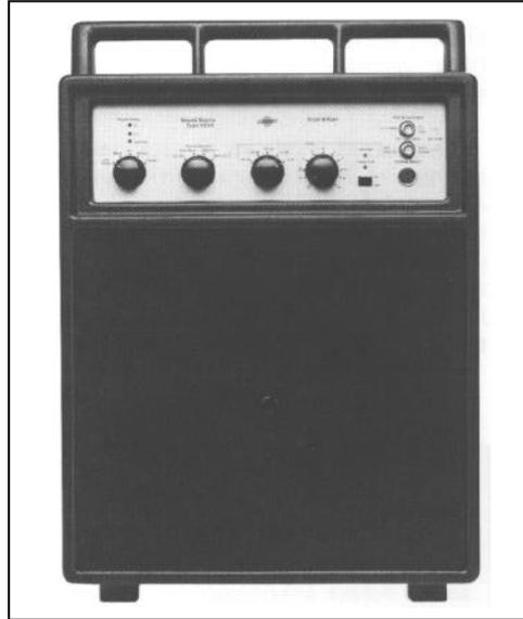
**Figura 5.5.** Fuente sonora 4224 de la firma comercial Brüel & Kjaer empleada en los ensayos.
