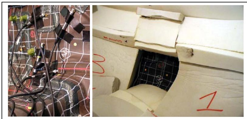
**Figura 2.26.** - A la izquierda varias sondas del tipo p-u miden la velocidad normal a una superficie de un automóvil. A la derecha el método de la ventana utilizado para medir la misma superficie con una sonda del tipo p-p.
