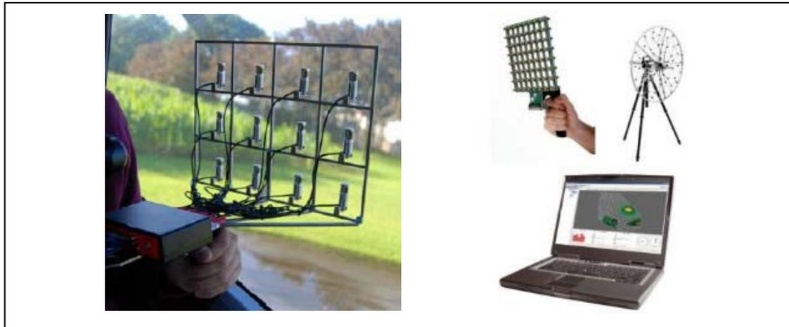
**Figura 2.29.-** Dos arrays de transductores de tecnología diferente utilizados para el estudio de campos sonoros. A la izquierda construido con sensores microflow y a la derecha con micrófonos.
