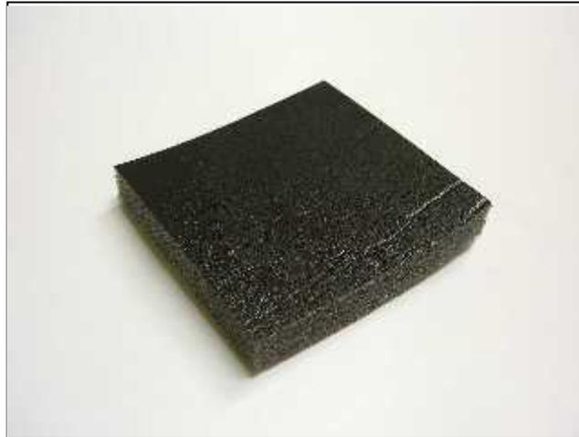
**Figura 5.3.** - Material aislante utilizado en el forrado del interior de la caja de ensayo.
