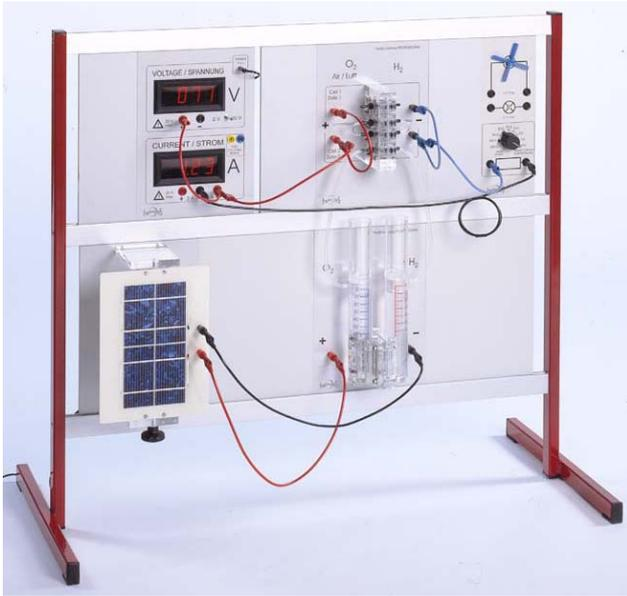
Figura 1: Sistema pila de combustible
