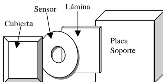
Figura 2: Elementos de una placa sensora -
