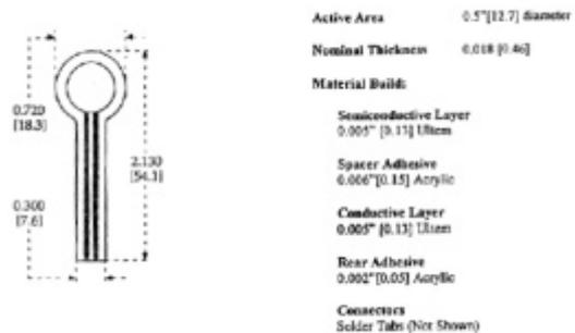
Figura 4: Características del sensor FSR
