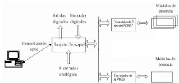
Figura 3: Estructura del controlador
