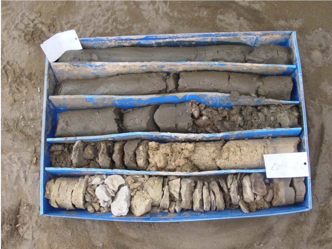
Foto 6. 15. Testigo continuo obtenido de 9 a 12 metros.
