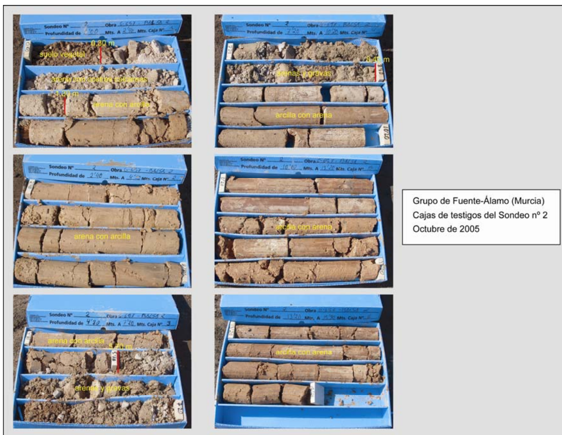
Figura 6. 87. Vistas de las cajas porta-testigos del sondeo nº 2.
