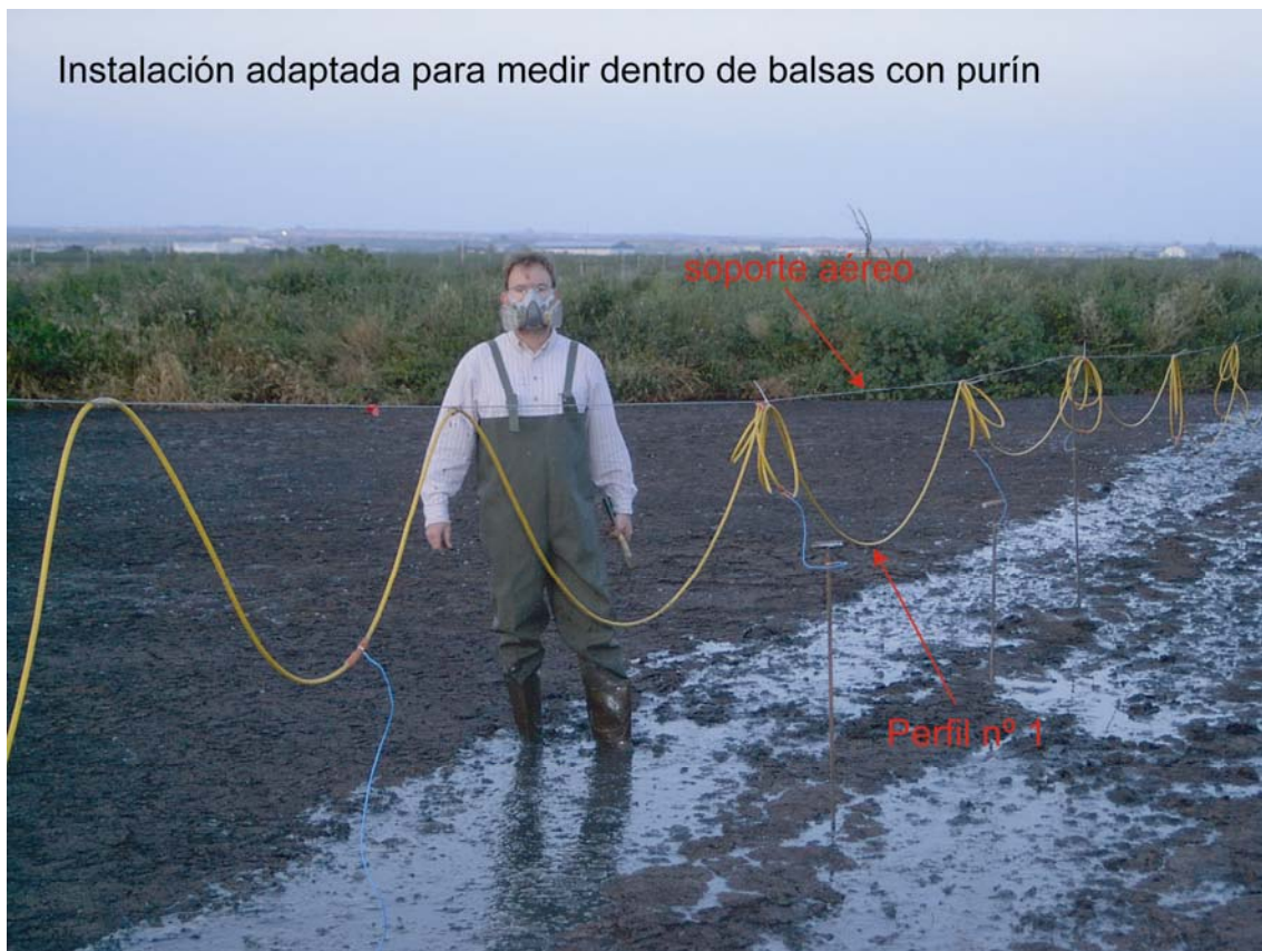
Foto 6. 36. Vista parcial del perfil n° 1 y el sistema de soporte aéreo empleado.
