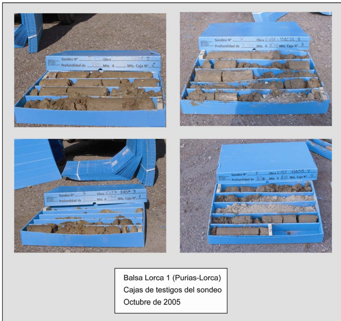
Figura 6. 113. Vistas de las cajas porta-testigos del sondeo de Lorca 1.
