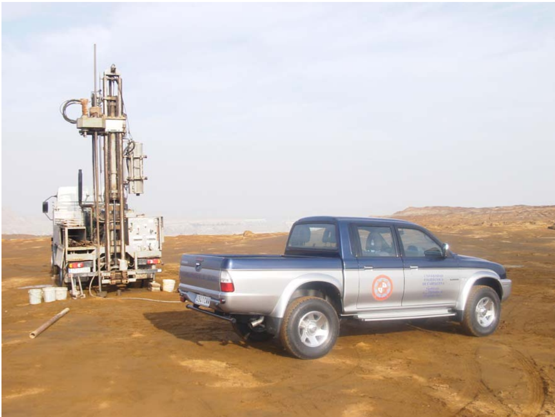
Foto 6. 28. Máquina para sondeos emplazada sobre el depósito “Brunita”.
