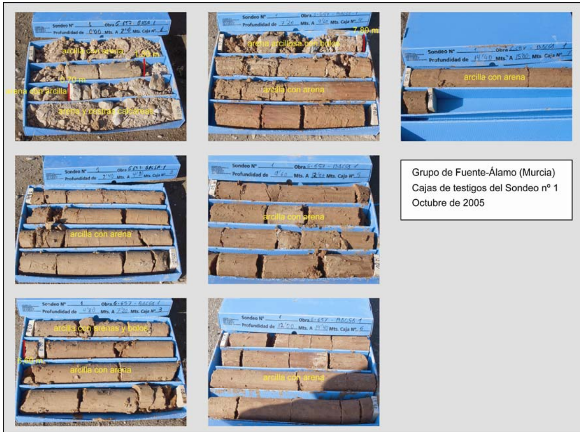
Figura 6. 85. Vistas de las cajas porta-testigos del sondeo n° 1.
