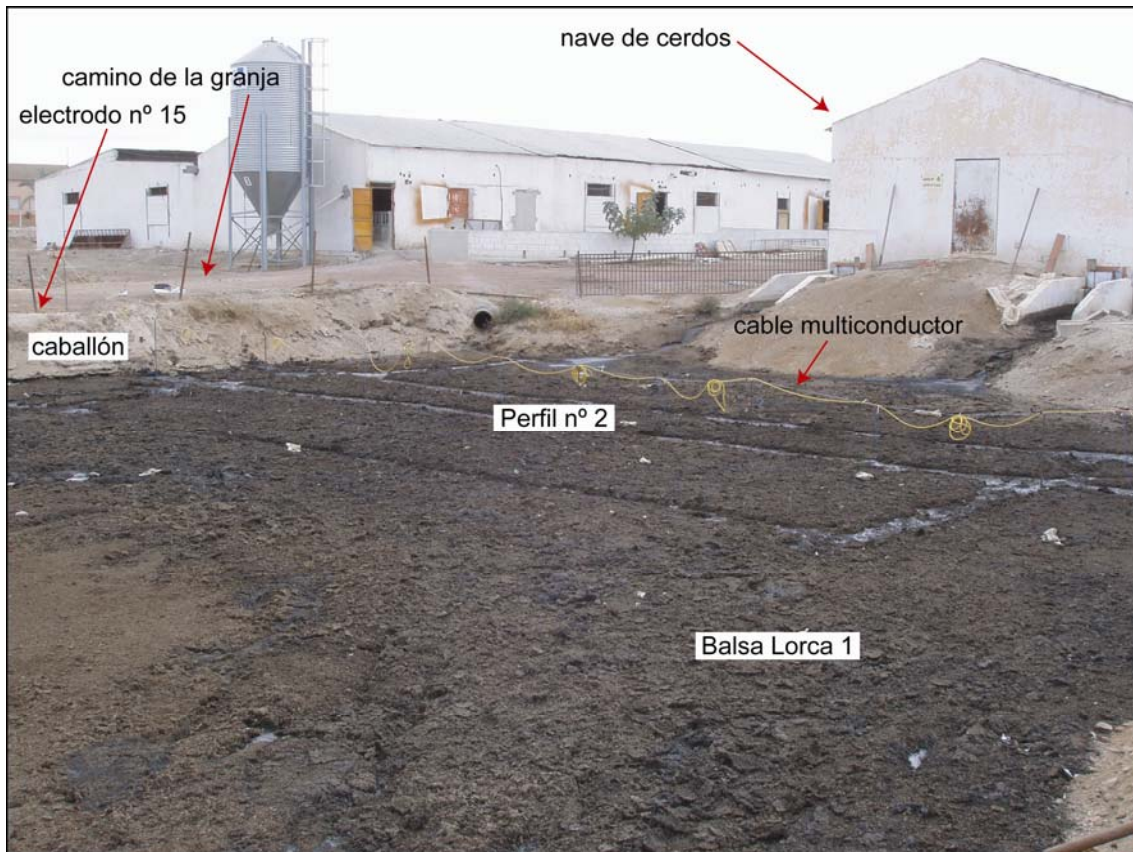
Foto 6. 49. Vista general del Perfil nº 2 instalado dentro de la balsa Lorca 1.
