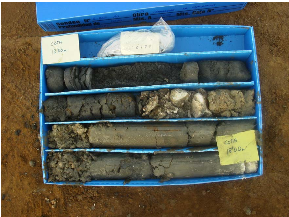
Foto 6. 29. Testigo continuo obtenido entre los 12 y los 15 metros.
