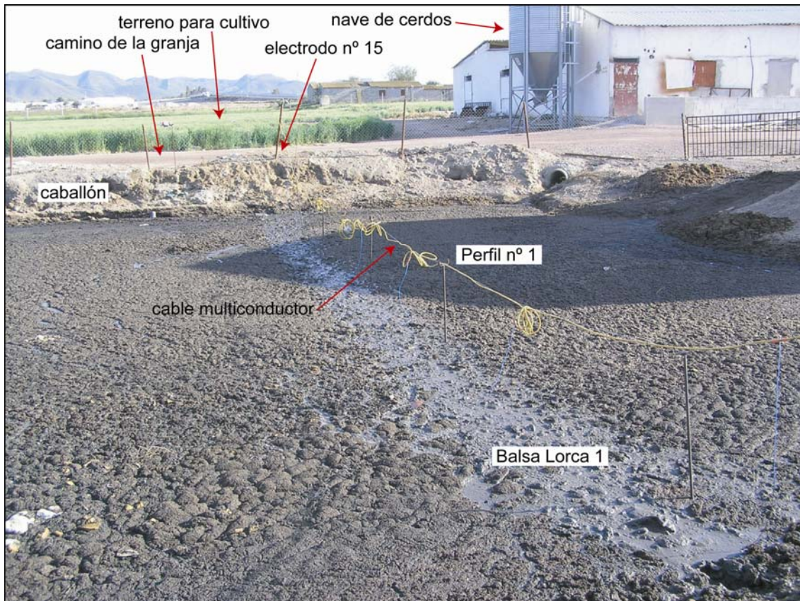
Foto 6. 50. Vista parcial del perfil nº 1 y el sistema de soporte aéreo empleado.
