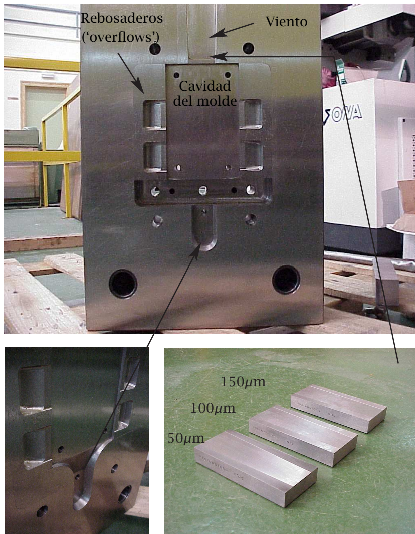
Inserto intercambiable para modificar el canal de colada
