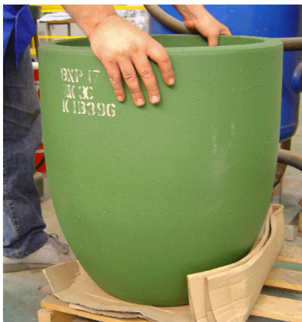
Figura 2.17: Crisol incluido en el horno de fusión y mantenimiento.
