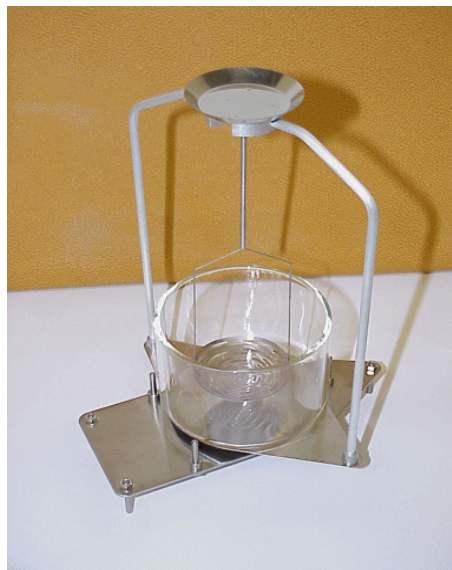
Figura 4.18: Dispositivo empleado para la medida de densidad en la balanza hidrostática.
