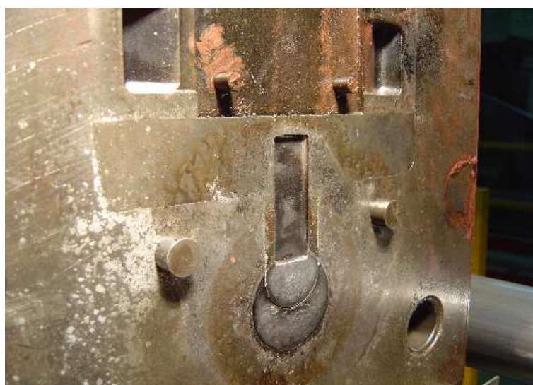
Figura 4.12: Fotografía de detalle de la pieza intercambiable montada en el molde.
