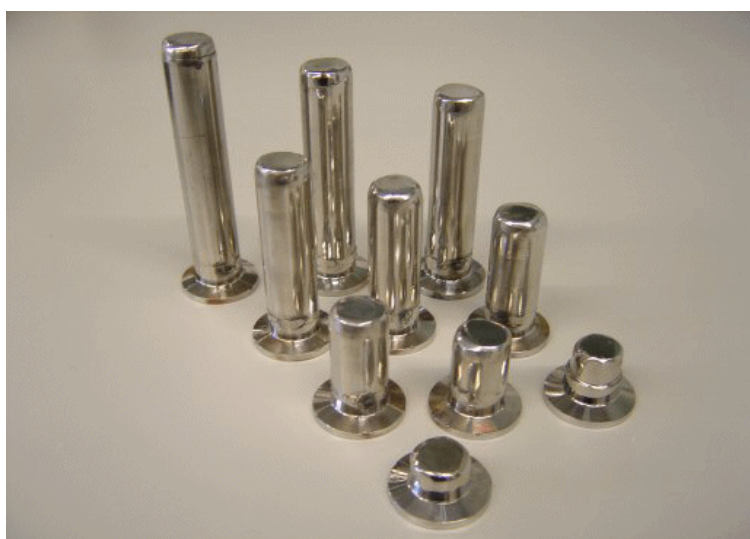
Figura 4.39: Conjunto de probetas fabricadas para la calibración del sistema.
