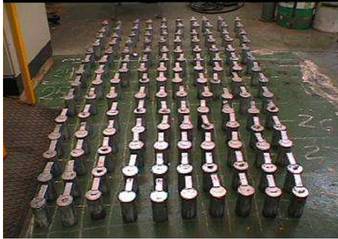
Figura 4.15: Ejemplo de una serie de piezas fabricadas con una fracción inicial de llenado f = 0,374 .
