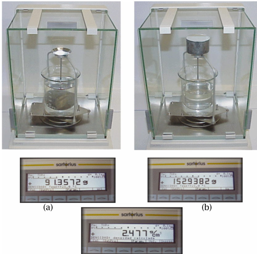
Figura 4.17: Procedimiento para la medida de densidad en la balanza hidrostática. a) Pesada en agua b) Pesada en aire.
