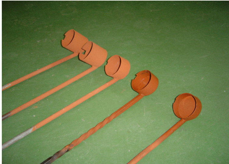
Figura 2.15: Cucharas de colada utilizadas durante los ensayos para diferentes valores de la fracción inicial de llenado de la cámara de inyección.
