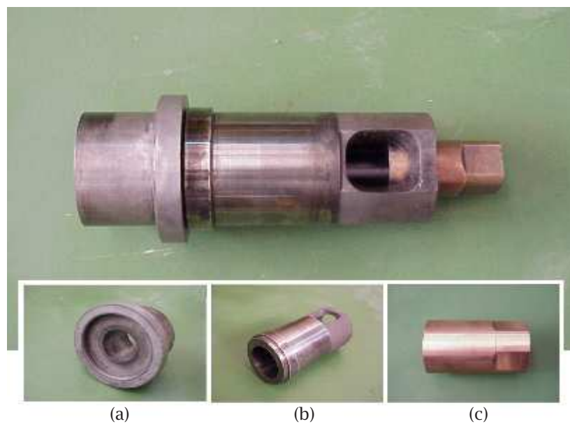
Figura 2.10: Cámara de inyección de 50 mm de diámetro formada por el conjunto (a) casquillo, (b) contenedor y (c) pistón.
