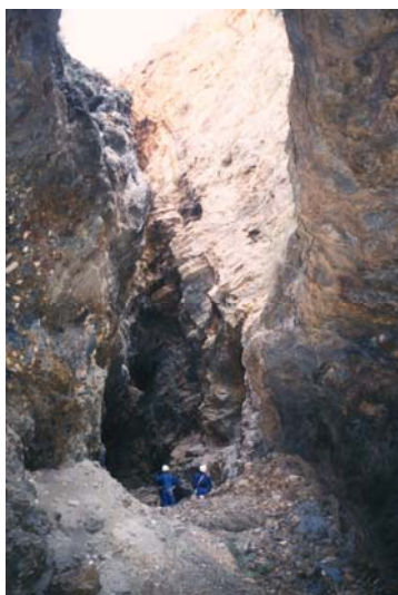
Foto 2.23. Mina Remunerada, en la carretera del 33. Filón de estaño de unos 200 m de longitud, 8 m de potencia media, más de 50 m de profundidad. A la izquierda brecha mineralizada en estaño. Junio, 2004.
