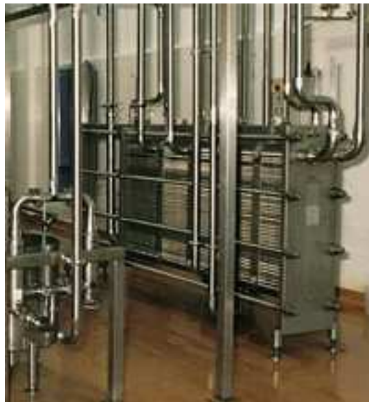
Fig. Nº 9. Equipo multientrada funcionando en un proceso de pasteurizado.
