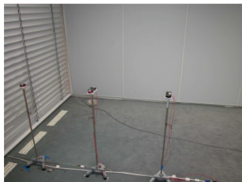
Figur 7. Opstillingen i referencerum for måling af farvetemperatur og luminansfordeling (CCD kamera), samt måling af horisontale belysningsstyrker.
