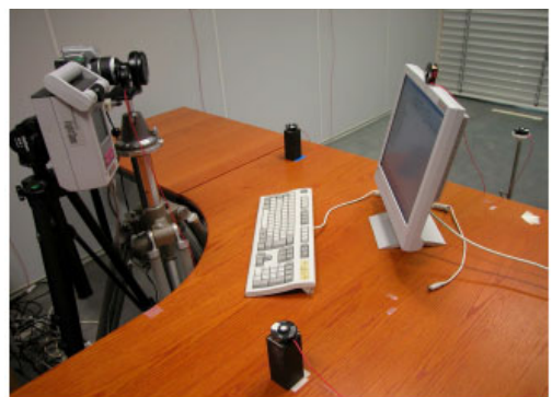
Figur 7. Opstillingen i referencerum for måling af farvetemperatur og luminansfordeling (CCD kamera), samt måling af horisontale belysningsstyrker.
