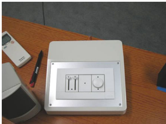
Figur 12. Reguleringsboksen hvor de to skydeknapper til venstre blev brugt til at ændre på farvetemperaturen mens drejeknappen til højre blev brugt til at hæve eller sænke belysningsniveauet i rummet.
