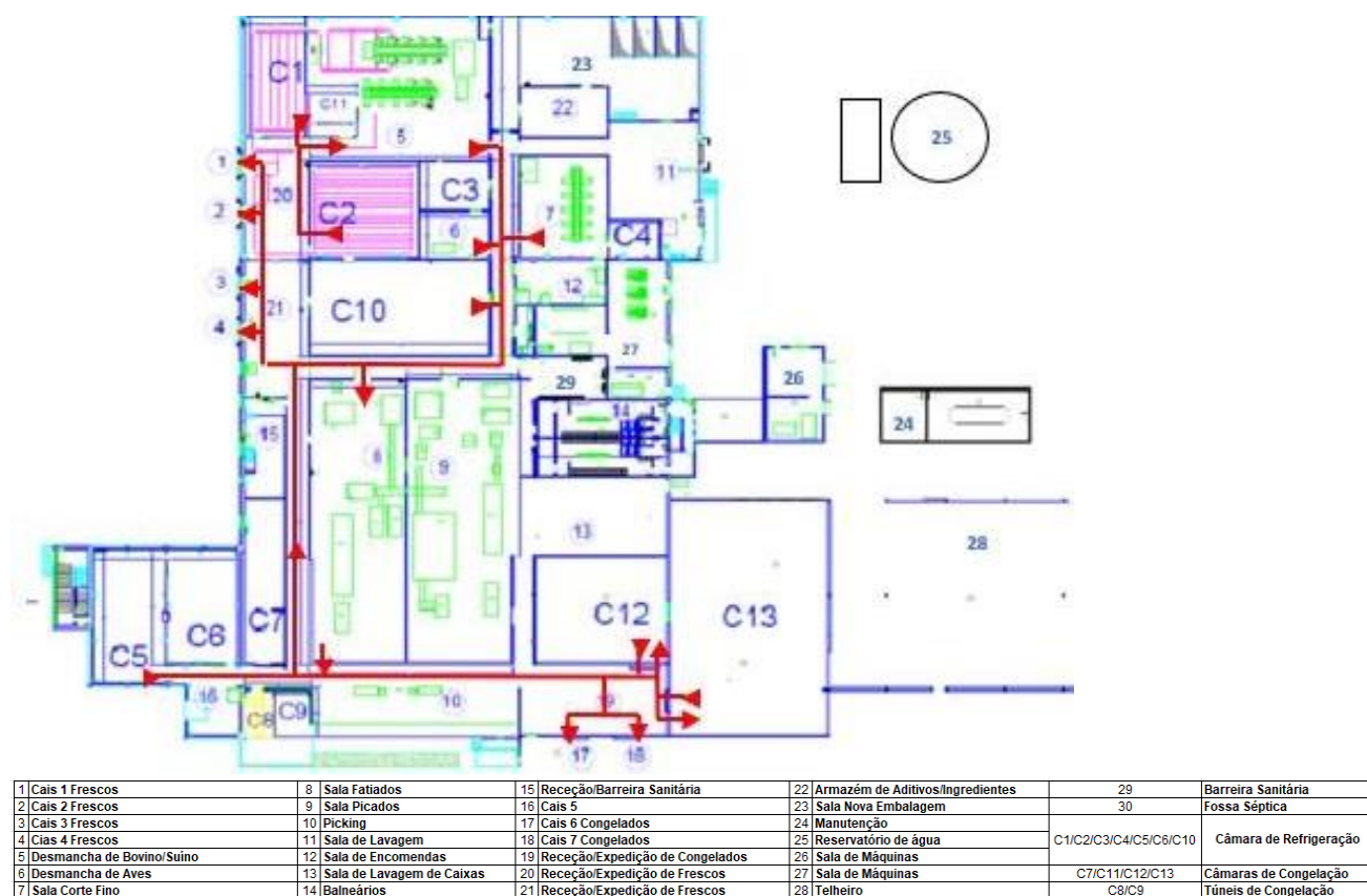
Figura 10: Fluxo do processo tecnológico da matéria prima
