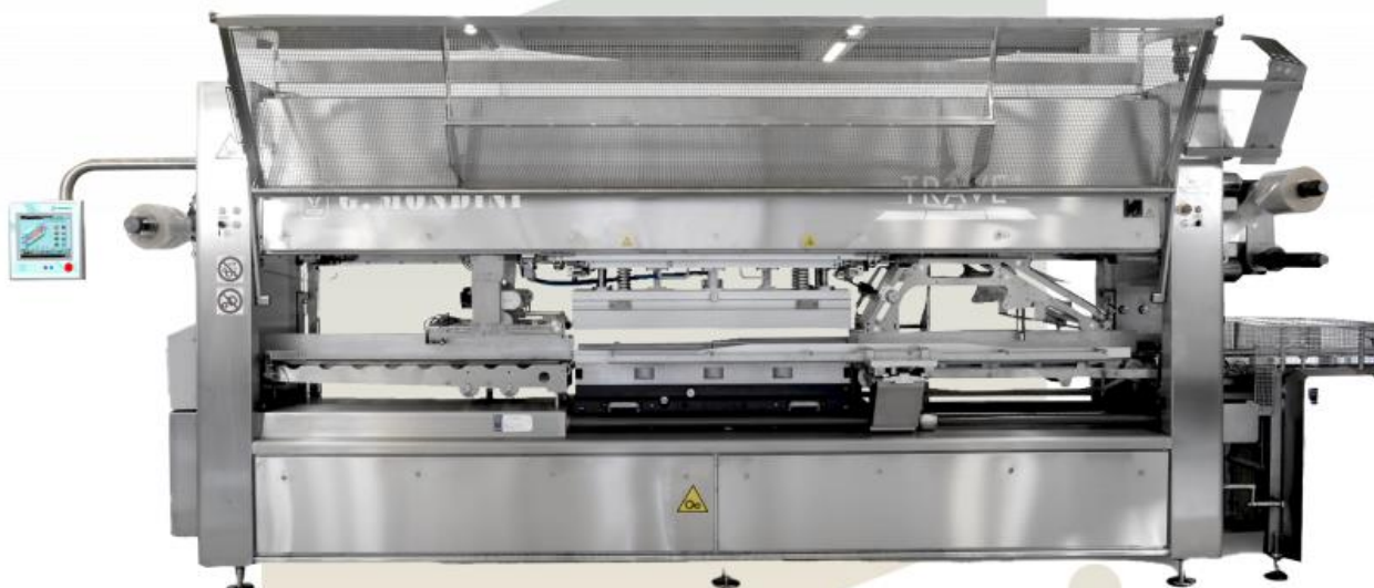
Figura 4: Equipamento utilizado na selagem da embalagem (Trave®) Fonte: G. Mondini
