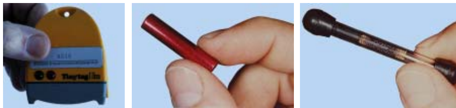
Figur 11. TinyTag Ultra , PFT sporgaskilde og PFT adsorptionsrør.
